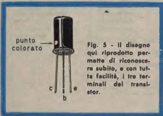
Fig. 5 - Il disegno qui riprodotto permette di riconoscere subito, e con tutta facilità, i tre terminali del transistor.
