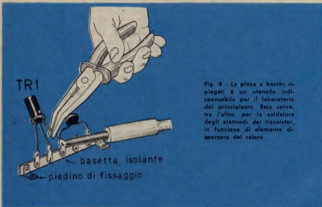
Fig. 4 - La pinza a becchi ripiegati è un utensile indispensabile per il laboratorio del principiante. Essa serve, tra l'altro, per la saldatura degli elettrodi del transistor, in funzione di elemento dissipatore del calore.
