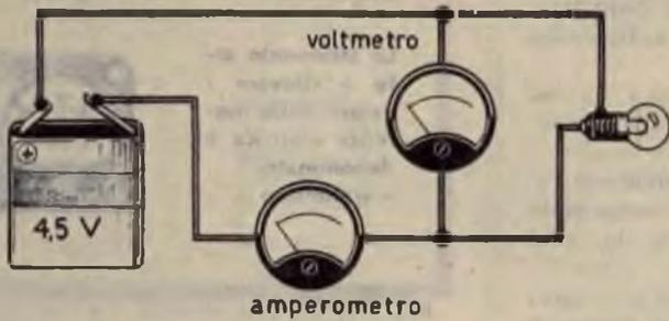
La potenza elettrica può essere misurata inserendo in serie al circuito un amperometro e collegando in parallelo un voltmetro.
