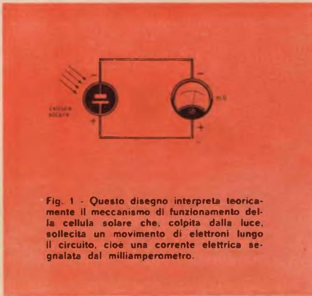
Fig. 1 - Questo disegno interpreta teoricamente il meccanismo di funzionamento della cellula solare che, colpita dalla luce, sollecita un movimento di elettroni lungo il circuito, cioè una corrente elettrica segnalata dal milliamperometro.
