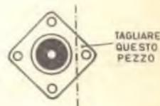
Fig. 6 - Coloro che, nella realizzazione dei bocchettoni, volessero utilizzare il contenitore TEK0 4B, dovranno apportare al contenitore la variante evidenziata nel disegno.
