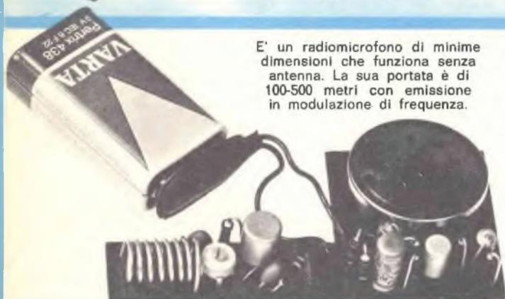
E' un radiomicrofono di minime dimensioni che funziona senza antenna. La sua portata è di 100-500 metri con emissione in modulazione di frequenza.
