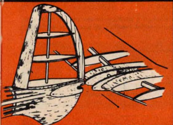
Fig. 5 - Esempio di connessione del piano di quota con la fusoliera che prende il nome di « attacco a forchetta ».
