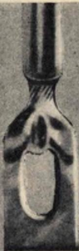
**SI** - Saldatura che va ritenuta ottima. Lo stagno è stato deposto in sufficiente misura, i fili sono stati ben attorcigliati e lo spellamento del filo è corretto.
