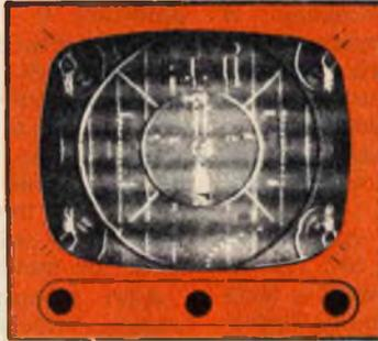
10) L'errata posizione del comando di sintonia fine apre l'ingresso nel canale video del televisore alle frequenze del suono. Le grosse righe orizzontali, instabili, che appaiono sul monoscopio rappresentano la immagine visiva delle onde sonore.
