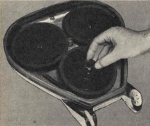
Le tre ruote motrici, dopo essere state inserite nei loro assi, vengono fissate mediante tre dadi, interponendo una rondella piatta e una spaccata; il foro va chiuso mediante apposita capsula di materiale isolante.
