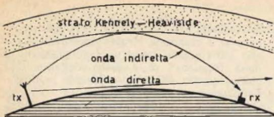
Fig. 9 - La propagazione indiretta delle onde elettromagnetiche, dovuta alla riflessione sullo strato di Kennely-Heaviside è risentita in particolar modo nelle trasmissioni ad onde lunghe.
