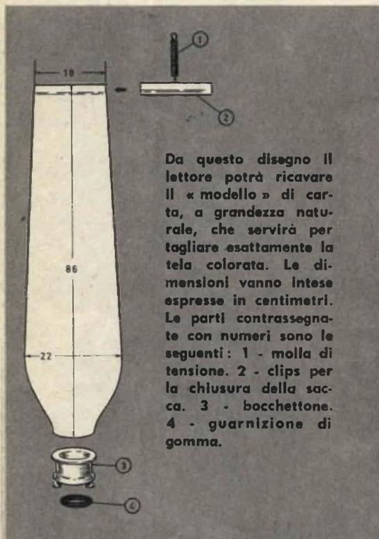
Da questo disegno il lettore potrà ricavare il « modello » di carta, a grandezza naturale, che servirà per tagliare esattamente la tela colorata. Le dimensioni vanno intese espresse in centimetri. Le parti contrassegnate con numeri sono le seguenti: 1 - molla di tensione. 2 - clips per la chiusura della sacca. 3 - bocchettone. 4 - guarnizione di gomma.
