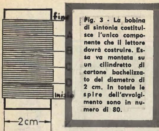
**Fig. 3 - La bobina di sintonia costituisce l'unico componente che il lettore dovrà costruire. Essa va montata su un cilindretto di cartone bachelizzato del diametro di 2 cm. In totale le spire dell'avvolgimento sono in numero di 80.**
