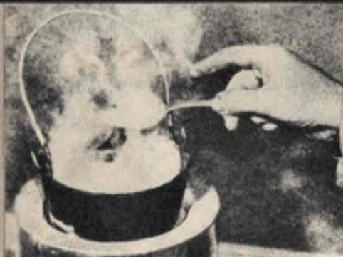
Lo zinco fuso si ossida rapidamente e tale ossido apparirà sotto forma di una schiuma verdastra alla superficie. Per effettuare un trattamento preciso ed uniforme dell'oggetto, è necessario assolutamente evitare di portare in esso questo ossido.
