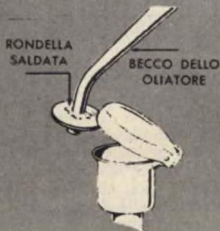
In molte macchine l'imboccatura dei condotti per l'immissione dell'olio lubrificante è munita di un piccolo coperchio di protezione. Tale coperchio, la cui presenza si renderebbe necessaria in ogni caso, serve per impedire nel condotto di lubrificazione l'ingresso della polvere e, più generalmente, di particelle estranee.
