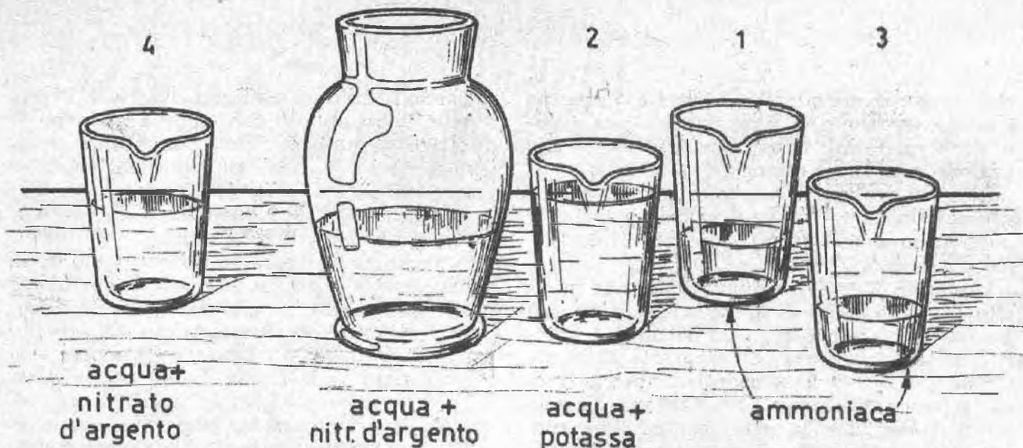
**VASO A** - La soluzione per argentare si ottiene con due soluzioni separate: una soluzione d'argento vera e propria (vaso A) e una soluzione riduttrice (vaso B), che viene mescolata con la soluzione d'argento immediatamente prima del suo impiego. Nel bicchiere 4 si prepara una soluzione di nitrato d'argento in acqua; a questa si aggiunge ammoniaca concentrata per mezzo di un contagocce; successivamente si aggiunge una soluzione di carbonato potassico.
