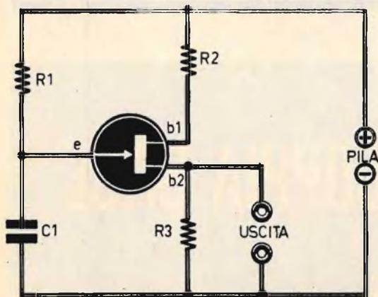
Fig. 5 - Esempio di circuito di oscillatore a rilassamento. Componenti:  $R_1 = 5-100.000$  ohm;  $R_2 = 100$  ohm;  $R_3 = 25$  ohm;  $C_1 = 100.000$  pF; pila = 12-30 V.
