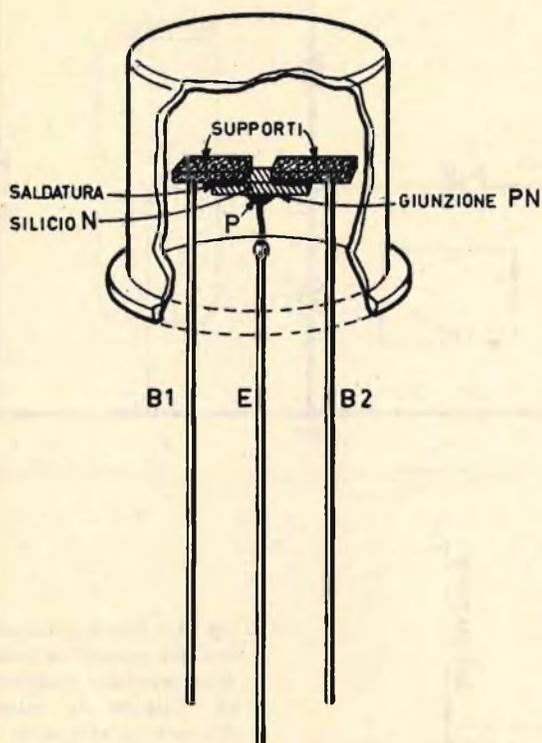
Fig. 1 - Vista in sezione di un transistor unigiunzione, chiamato anche diodo a doppia base. Si riconoscono i suoi tre elettrodi: B1 - E - B2.
