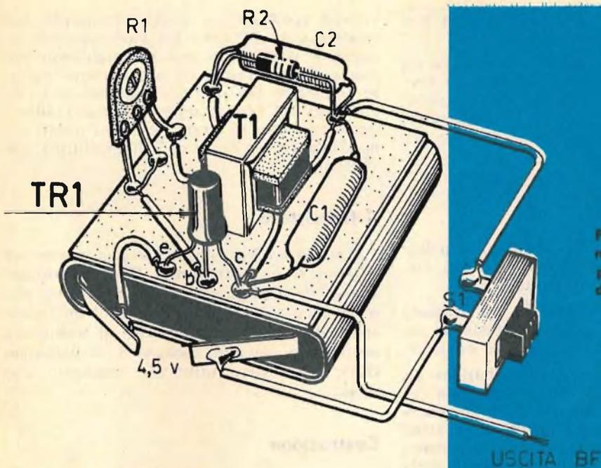
Fig. 2 - Piano di montaggio dell'apparato oscillatore di frequenza.
