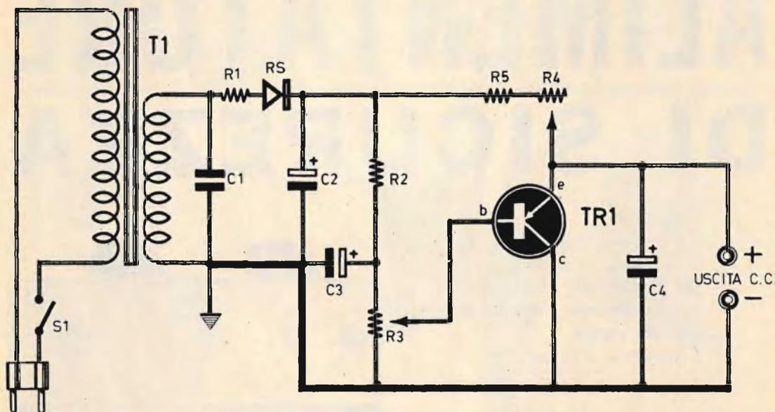
Fig. 1 - Circuito teorico dell'alimentatore di sicurezza per ricevitori a transistori.
