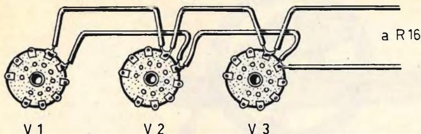
**Fig. 3 - Realizzazione pratica del circuito di accensione dei filamenti delle tre valvole dell'amplificatore.**
