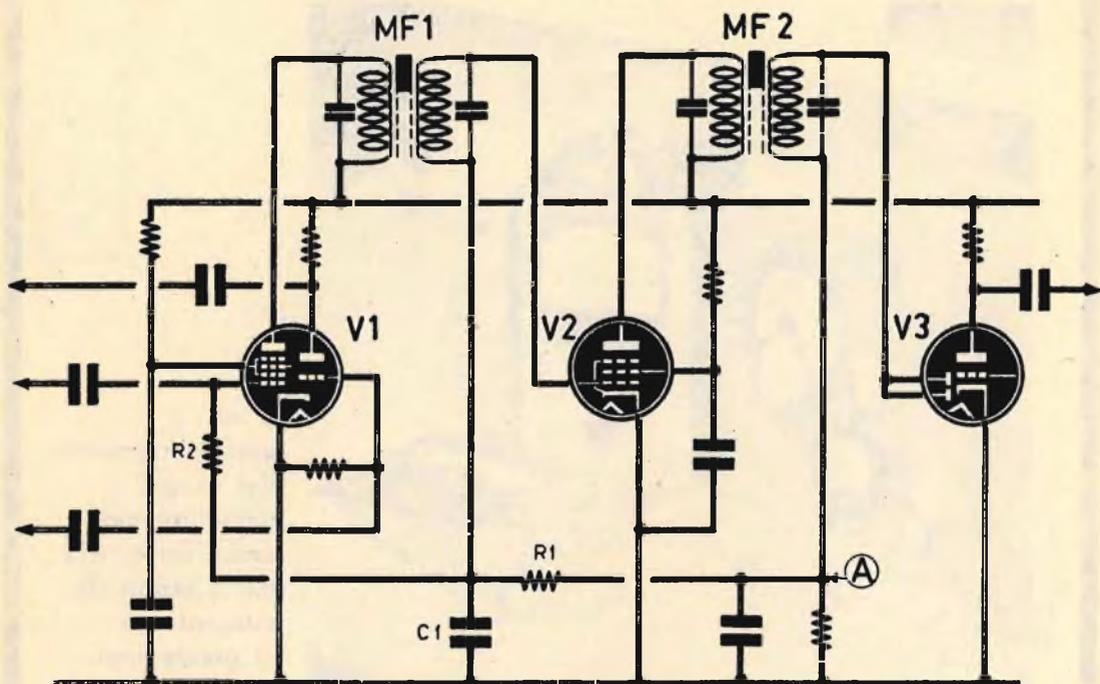
Fig. 1 - Nei comuni ricevitori supereterodina la tensione CAV viene prelevata nel punto A; il circuito relativo è quello indicato con tratto nero.
