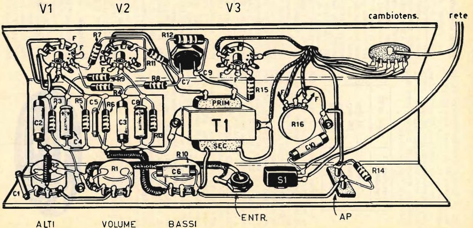
rita dal secondario del trasformatore d'uscita alla resistenza R5 di catodo della valvola pre-amplificatrice V1.
