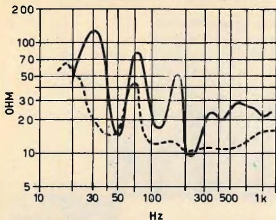
Fig. 1 - Il diagramma a tratto intero rappresenta la curva di impedenza di un altoparlante standard montato sul mobile acustico descritto nel testo; la curva tratteggiata rappresenta l'oscillogramma ottenuto con un altoparlante di nota marca.
