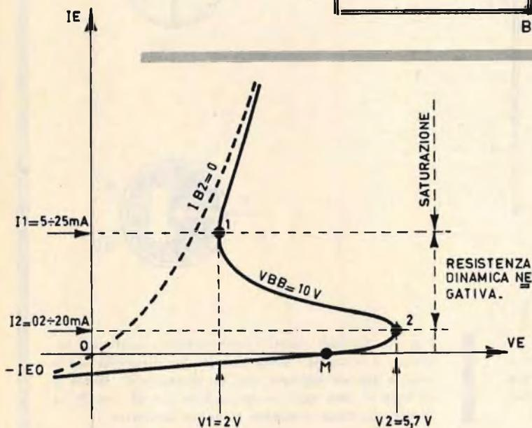
Fig. 4 - Curve caratteristiche del circuito di entrata di un transistor unigiunzione. Quando la corrente  $I_{B2} = 0$ , si ritrova la curva (tratteggiata) classica di un diodo. La curva del transistor unigiunzione è a tratto pieno e presenta una zona di resistenza dinamica negativa.
