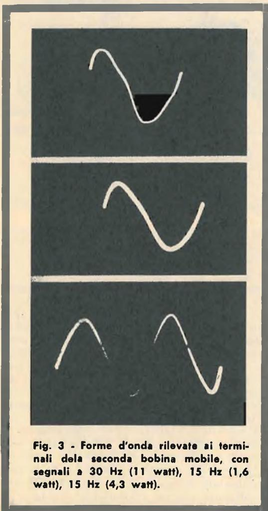
Fig. 3 - Forme d'onda rilevate ai terminali della seconda bobina mobile, con segnali a 30 Hz (11 watt), 15 Hz (1,6 watt), 15 Hz (4,3 watt).
