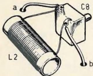
Fig. 3 - Il condensatore variabile C8 e la bobina di sintonia L2 devono essere montati nella parte superiore del telaio, con lo scopo di evitare l'insorgere di fischi ed inneschi. Il montaggio viene semplificato dall'uso di un supporto di materiale isolante.
