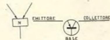
Fig. 3 - Transistore a punta e suo simbolo.
