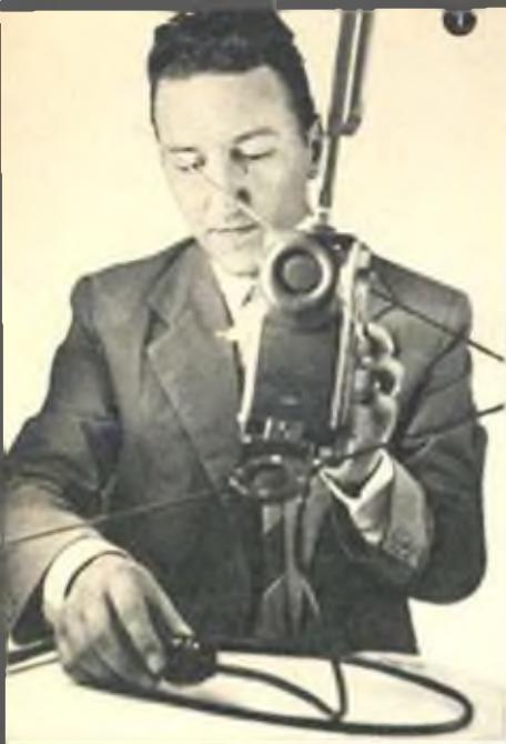
1 Appareto riceotrasmettitore portatile a modulazione di frequenza con antenna a frusta o «gold-plane». Si chiama RT 101. Pesa kg. 1,450. Funziona entro il raggio di 50 chilometri.
