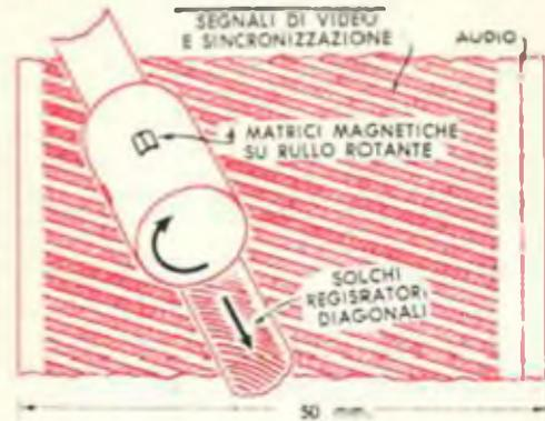
Sul nastro più largo del sistema Ampex bianco e nero, le matrici rotanti sono composte di solchi visivi diagonali. Questo schema — dove è più facile registrare il bianco e nero — permette una velocità moderata di cm. 37 e mezzo al secondo. Un programma di un'ora viene inciso sulla bobina che vedete qui sotto.
