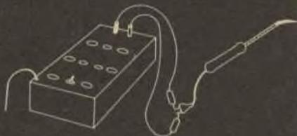
PROVA DELLA RESISTENZA DEL SALDATORE - LA LAMPADINA DEVE ACCENDERSI
