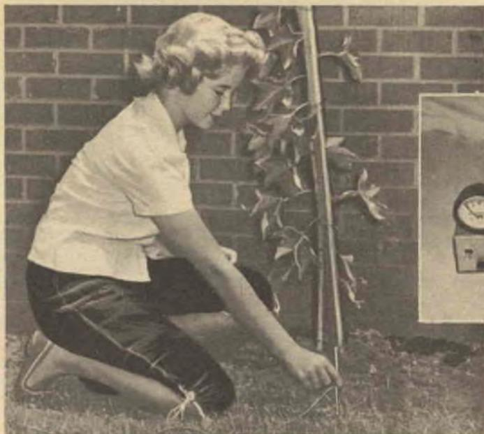
Un probe viene piantato ad una delle estremità del terreno che potrà essere così innaffiato automaticamente.
