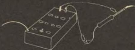
PROVA DI ISOLAMENTO DEL SALDATORE - LA LAMPADINA NON DEVE ACCENDERSI
