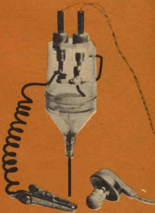
Unità finita e montata in una scatoletta di plastica.
