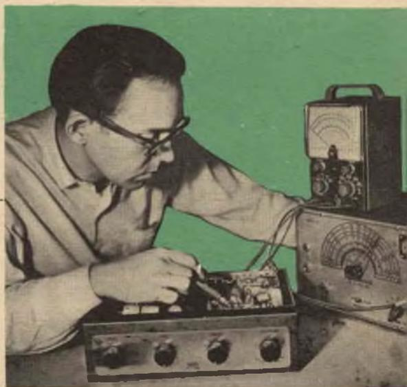
da all'altoparlante; l'amplificatore riceve queste debolissime tensioni di segnale e le converte in forti correnti che fanno muovere i coni degli altoparlanti. Se esaminiamo perciò la tensione di segnale in ogni stadio, possiamo avere una buona idea del contributo che ogni valvola dà all'amplificazione del segnale.
