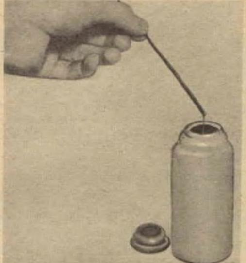
Se avete un barattolo di vernice isolante, potrete disporre di un grande assortimento di tubetti isolanti: volendo isolare un pezzo di filo nudo immergetelo semplicemente nel barattolo e poi appendetelo per farlo seccare. Ripetendo il trattamento tre o più volte potrete isolare il filo, in modo che possa sopportare tensioni fino a 220 V. Per applicare l'isolante ai fili che non è possibile immergere nella vernice, usate un pennellino.
