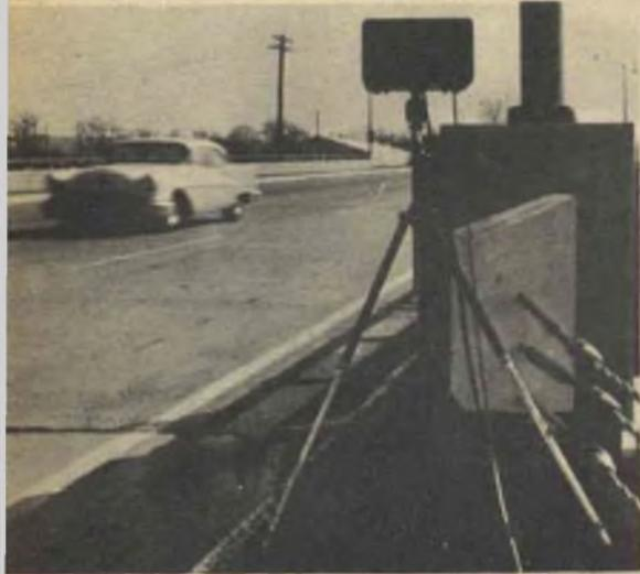
**1** Una scatola montata su un treppiede controlla ogni automobile sulla strada N° 17 a Mahwah (New Jersey); misura la velocità grazie al cambiamento della lunghezza dell'onda riflessa dalla macchina.
