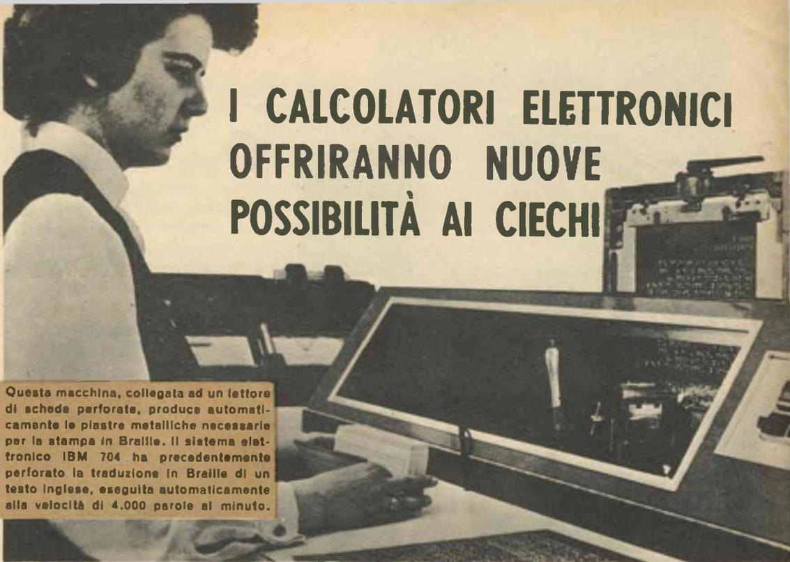
Questa macchina, collegata ad un lettore di schede perforate, produce automaticamente le piastre metalliche necessarie per la stampa in Braille. Il sistema elettronico IBM 704 ha precedentemente perforato la traduzione in Braille di un testo inglese, eseguita automaticamente alla velocità di 4.000 parole al minuto.
