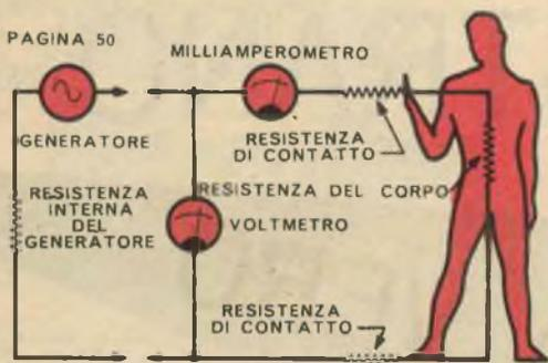
La quantità di corrente in un circuito « di scossa » è determinata dalla tensione applicata in relazione con la somma della resistenza interna del generatore, della resistenza del corpo e della resistenza di contatto nei punti in cui il circuito è chiuso.
