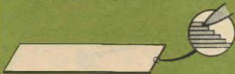
Fig. 2 - Pila di carta e visione ingrandita del movimento della puntina sul bordo della pila; ogni foglio produce un impulso di tensione.
