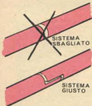
Dovendo unire insieme due pezzi di tondino o di filo grosso, un giunto sovrapposto, stagnato e scaldato, risulterà altrettanto forte come il tondino stesso; il semplice giunto accostato invece si romperà facilmente.
