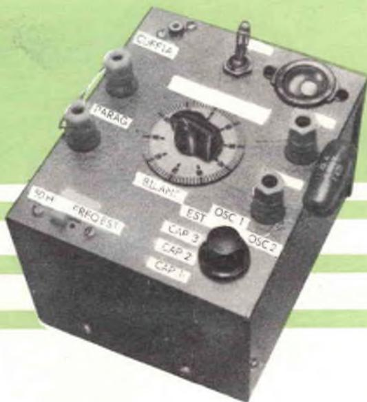
**E**cco un generatore audio, un ponte per resistenza-capacità ed un indicatore di sintonia e modulazione racchiusi in un solo strumento. Questo tester universale di dimensioni ridotte occuperà poco spazio sul vostro banco di lavoro e vi farà risparmiare parecchio tempo nel montaggio e nel controllo di apparecchi autocostruiti.
