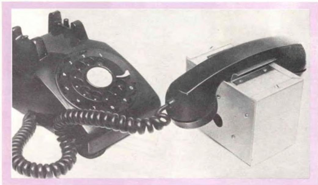
Un microinterruttore posto dentro la scatola controlla il movimento del carillon, mantenendolo in funzione finché non si solleva il microtelefono.
