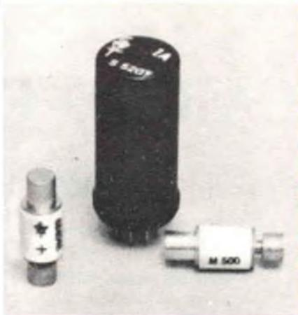
La sistemazione dei diodi negli involucri di valvole permette di sostituirli a 5U4, 5W4, 5Y3, 6X4 e ad altre valvole raddrizzatrici; diodi incapsulati in cartucce sono ora usati nei televisori di modello più recente.
