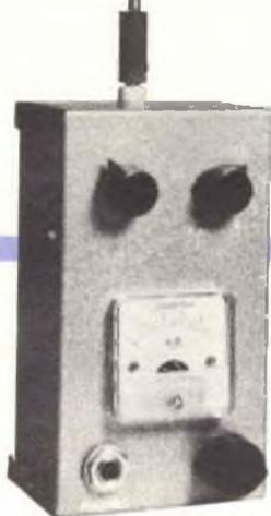
Il misuratore di campo è provvisto di un jack di uscita per l'inserzione di una cuffia usata per controllare la qualità audio di un trasmettitore. L'inserzione di una cuffia non provoca alcun mutamento nella sensibilità o nell'indicazione dello strumento.
