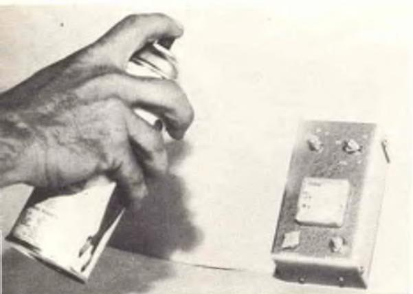
Per proteggere le scritte o le decalcomanie del pannello si usa una vernice plastica trasparente a spruzzo. Le parti del pannello frontale devono essere ben protette durante la spruzzatura.
