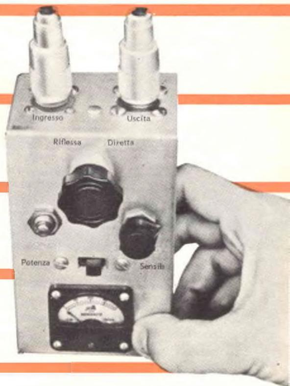
**Q**uesto semplice apparecchio consente di misurare la potenza effettivamente irradiata dall'antenna; lasciandolo permanentemente inserito misura in ogni istante la potenza irradiata. Inoltre può essere usato per le operazioni preliminari di sintonia del trasmettitore e dell'antenna per ottenere il miglior rapporto di onde stazionarie.
