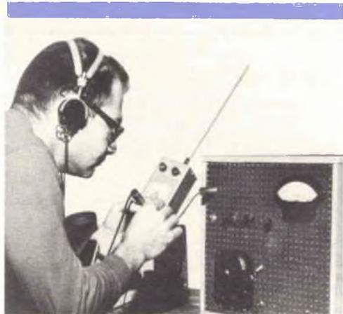
Un misuratore d'intensità di campo è uno dei più pratici strumenti a portata di mano di un radioamatore: infatti può essere usato per controllare e sintonizzare un trasmettitore od un'antenna o per scoprire chi produce armoniche.
