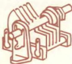
2 Quando il condensatore di sintonia di un radiorecettore è tutto aperto, l'apparecchio è sintonizzato su un estremo della gamma, e precisamente sulle frequenze più basse della gamma.
