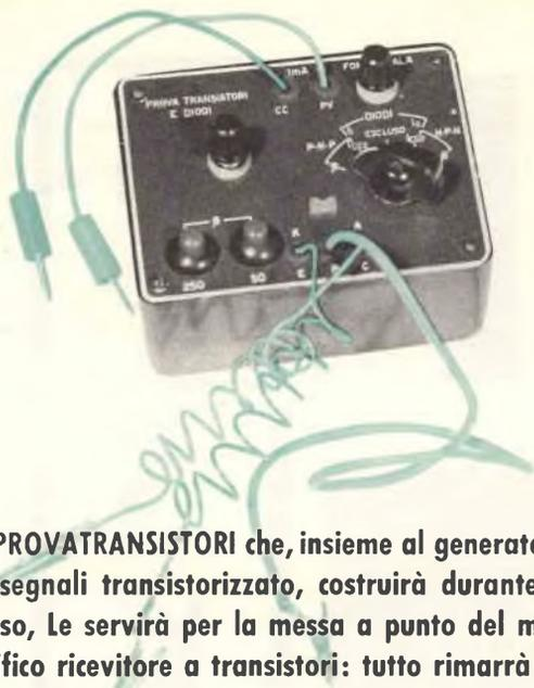
IL PROVATRANSISTORI che, insieme al generatore di segnali transistorizzato, costruirà durante il corso, Le servirà per la messa a punto del magnifico ricevitore a transistori: tutto rimarrà di Sua proprietà.
