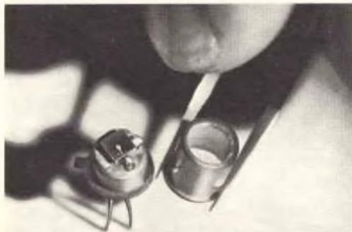
la radiazione visibile sia per la radiazione infrarossa. A differenza dei normali fotodiodi, non presenta l'inconveniente della perdita di sensibilità quando viene esposto alla luce del sole; esso può essere usato a temperature che giungono fino a 120 °C senza alcuna perdita di sensibilità. Il rivelatore a cristallo è montato in una comune custodia per transistori tipo TO-18 modificata con l'aggiunta di una piccola finestra protetta da un vetro.
