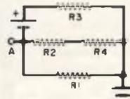
**7** Anche in questo caso è bene ridurre i resistori  $R_1$ ,  $R_2$  e  $R_4$  ad uno solo e fare nuovamente ricorso alla legge di Ohm. La corrente che passa attraverso
