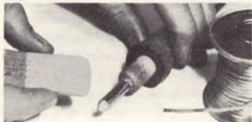
Una gomma da inchiostro può togliere perfettamente la patina di ossido dalla punta di un saldatore freddo. A differenza della lima, la gomma non asporta metallo; ciò prolungherà la durata della punta del saldatore evitando di doverla sbiancare di frequente.
