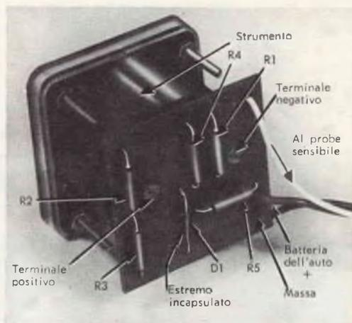
L'intero strumento può essere montato su una staffetta di alluminio foggiate ad angolo e fissata con bulloncini alla parte inferiore del cruscotto.
