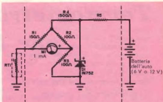
Un circuito a ponte è il cuore del misuratore elettronico di temperatura. La resistenza del termistore RT1 varia con la temperatura squilibrando il ponte ed introducendo un passaggio di corrente attraverso M1 la cui scala è tarata in °C.
