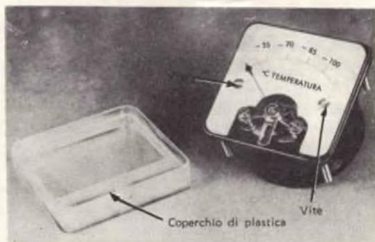
Il coperchio di plastica dello strumento deve essere tolta per consentire l'installazione del nuovo quadrante. Fissate la nuova scala con collante.
