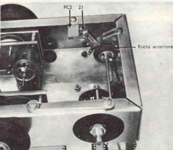
**Il montaggio di PC2, di I1 e della ruota anteriore è chiaramente illustrato nella foto a sinistra. La linguetta di ancoraggio per il resistore R1 può essere sistemata sotto I1. Le ruote posteriori con relativi mozzi incollati sono raffigurate nella fotografia qui sotto, insieme all'alberino che è usato per centrare i mozzi.**
