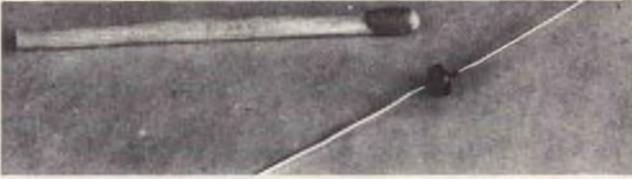
Un termistore del tipo a disco non è molto più grande della capocchia di un comune fiammifero; nonostante ciò funge da unità sensibile del dispositivo misuratore di temperatura.
