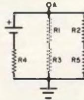
**5** Una semplice occhiata al circuito suggerisce che i resistori  $R_1$ ,  $R_2$ ,  $R_3$  e  $R_5$  devono essere sommati in modo da ricavare il resistore equivalente (il cui valore sarà di  $6 \Omega$ ); quindi, ritornando alla legge di Ohm si trova che il potenziale del
