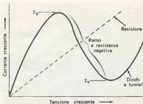
Fig. 1 - Tipiche curve di tensione e corrente di un resistore e di un diodo a tunnel. Il ramo a resistenza negativa della curva del diodo a tunnel è compreso fra  $I_p$  (corrente di picco) e  $I_v$  (corrente di valle). Da  $I_v$  la corrente riprende a salire.
