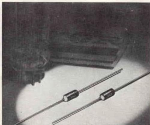
In tutto l'apparecchio si usano componenti di tipo comune. L1/L2 è una normale bobina di aereo per onde medie; C1 è un condensatore elettrolitico da 100  $\mu$ F - 6 V; S1 è un interruttore a corsoio od a levetta. Nel circuito si può impiegare qualsiasi diodo di tipo comune la cui resistenza diretta sia di circa 20  $\Omega$  e la resistenza inversa di circa 5.000  $\Omega$ .
