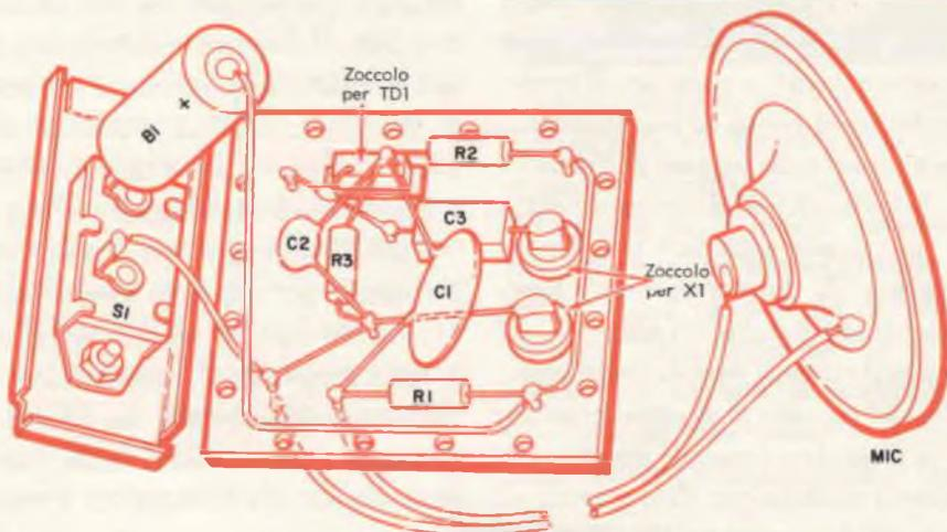
L'intero trasmettitore, ad eccezione dell'interruttore S1, di B1 e del microfono è montato su un telaio di 5 x 5 cm. Per semplicità si è illustrato un solo estremo del telaio.
