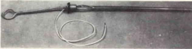
Il termistore può essere montato sia sull'astina dell'olio (in alto) per misurare la temperatura dell'olio, sia in un semplice alloggiamento (in basso) se si vuole controllare la temperatura della testa dei cilindri.
