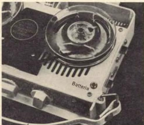
la fedeltà della registrazione a vantaggio del tempo di registrazione, specialmente quando si deve registrare soltanto una conversazione. Il tempo di registrazione di un comune registratore portatile può essere aumentato approssimativamente del venticinque per cento mediante l'aggiunta di un resistore da  $2 \Omega$  (R14) in serie al motore, come indicato in fig. 3. Questo resistore diminuisce la velocità del motore principale, diminuendo la velocità del nastro ed
