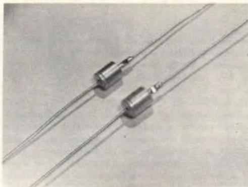
Le unità sono state progettate in accordo con le caratteristiche JEDEC per i tipi compresi tra 1N3075 e 1N3081.
