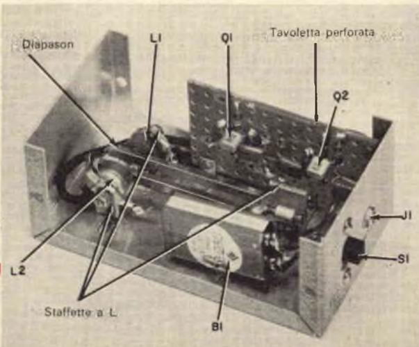
Le bobine ed il diapason sono supportati da staffette a L. La disposizione delle altre parti non è critica; anche il telaio isolante di materia plastica è montato su staffette.
