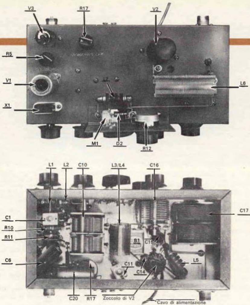
Le fotografie della parte superiore ed inferiore del telaio del trasmettitore mostrano come devono essere disposti tutti i componenti principali.
