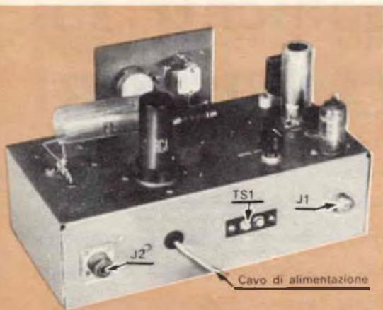
Disposizione dei componenti sul lato superiore e posteriore del telaio da 8 x 25 x 13 cm del trasmettitore.
