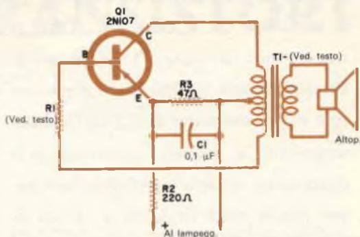
o fissato al gruppo dello sterzo. Per collegare l'unità alla linea del lampeggiatore usate un filo flessibile facendo attenzione ad osservare la polarità indicata dallo schema.
