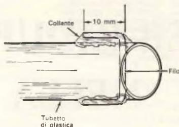
Un attrezzo per regolazioni può essere realizzato rapidamente mediante un tratto di tubo di plastica ed un corto pezzo di filo rigido per collegamenti. Praticate due fori attraverso il tubo ed inserite il tratto di filo lasciando circa 10 mm in più da ciascun lato del tubo. Quindi ripiegate indietro le estremità del filo e fissatelo al tubo con collante. Il diametro esatto del tubo e la posizione del foro dipendono dalle dimensioni del componente che dovete regolare.
