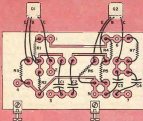
gnati con numeri corrispondenti sullo schema dei collegamenti qui sopra riportato e mostrano dove si devono collegare le bobine e la batteria.
