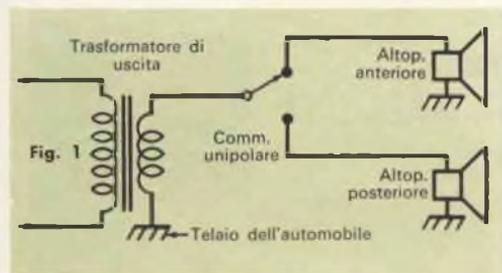
riore o quello posteriore, ma mai entrambi. Una disposizione più complessa (illustrata in fig. 2) richiede l'uso di un particolare commutatore a tre posizioni. In questo sistema si può scegliere l'uno o l'altro altoparlante, oppure si possono anche inse-
