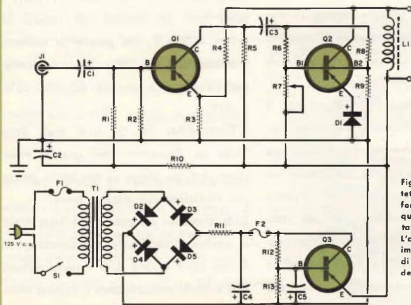
Fig. 1 - Un transistoro tetraodo di potenza (Q2) fornisce 5 W a 50 kHz in questo circuito presentato dalla Honeywell. L'apparecchio ha una impedenza di ingresso di 300  $\Omega$  ed un'impedenza di uscita di 10  $\Omega$ .
