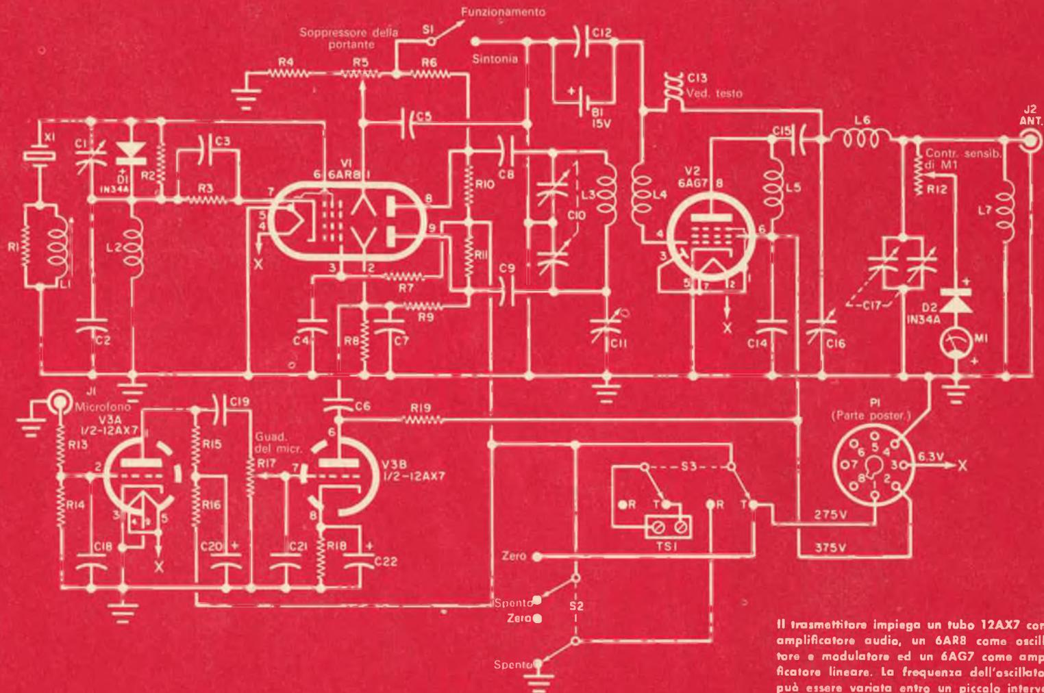
Il trasmettitore impiega un tubo 12AX7 come amplificatore audio, un 6AR8 come oscillatore e modulatore ed un 6AG7 come amplificatore lineare. La frequenza dell'oscillatore può essere variata entro un piccolo intervallo regolando adeguatamente il nucleo di L1.
