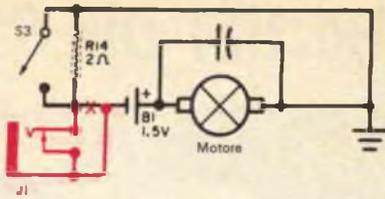
Fig. 4 - Il jack subminiatura J1 consente di comandare a distanza il registratore mediante un qualsiasi tipo di interruttore a mano od a pedale.
