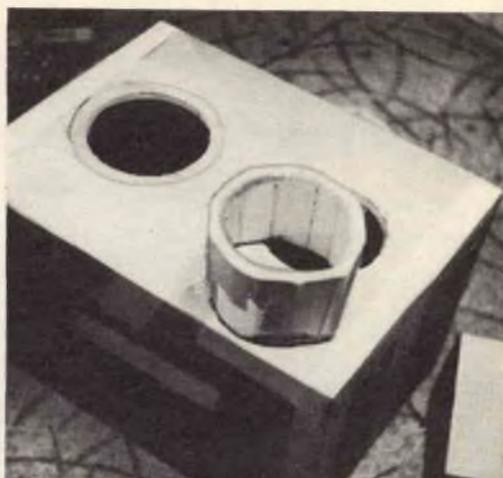
Il condotto si fa arrotolando una striscia di cartone ondulato da 9 x 90 cm in modo da formare un tubo del diametro interno di 13,5 cm. Per irrigidire il tubo si usa nastro di carta gommata.
