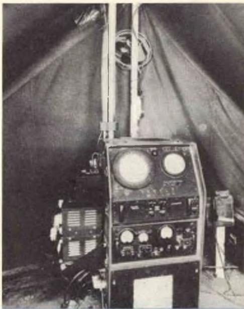
Ecco il radar AN/TPS-3 installato in una tenda militare. Fu il primo radar ad alta potenza funzionante nella gamma dei 600 MHz.
