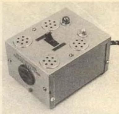
Per dissipare il calore generato durante il funzionamento non solo si deve montare D1 su un radiatore, ma si devono praticare nella scatola fori di ventilazione.
