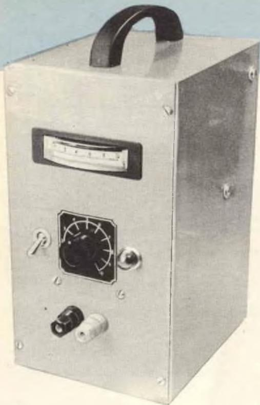
Ecce come appare il caricabatterie ultimato. Nelle fotografie non sono visibili due fori da 2 cm ciascuno praticati sul fondo e sul pannello posteriore e guarniti di griglie per la ventilazione.
