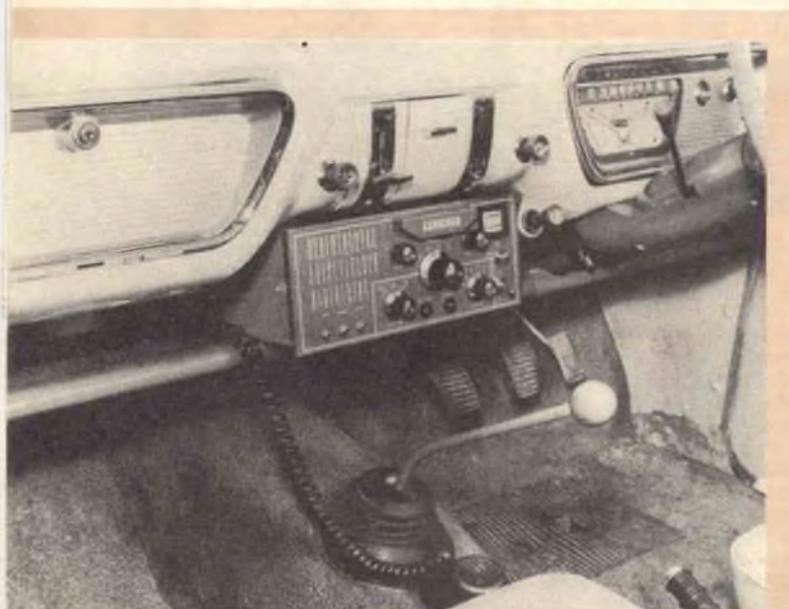
Unità intercambiabile usata nelle stazioni ricetrasmittenti a singola banda laterale sia mobili sia fisse. In questa unità a transistori ricevente/eccitatrice i controlli sono riuniti per una facile manovra.
