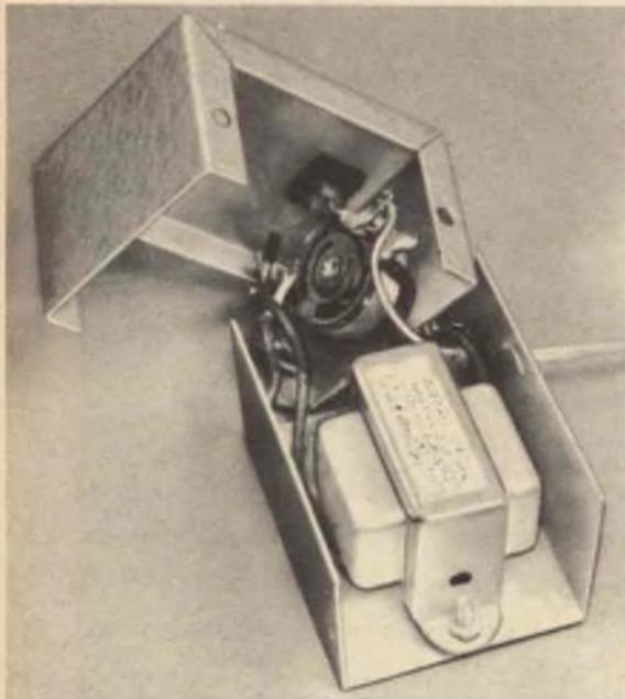
Anche se un po' stretti tutti i componenti della bilancia stereo possono essere montati in una scatoletta d'alluminio miniatura. Come si vede il potenziometro è del tipo a filo; si può però usare anche un potenziometro del tipo a grafite.
