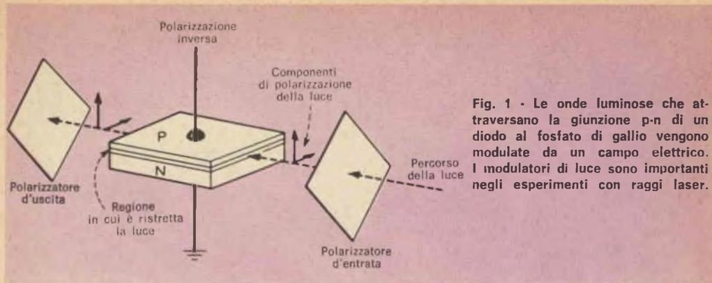
Fig. 1 - Le onde luminose che attraversano la giunzione p-n di un diodo al fosfato di gallio vengono modulate da un campo elettrico. I modulatori di luce sono importanti negli esperimenti con raggi laser.
