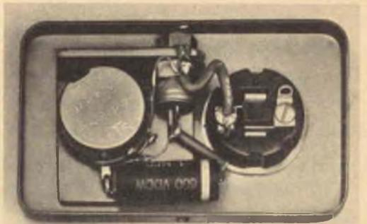
Il radiatore d'alluminio sistemato nell'interno della scatola e la targhetta che si trova all'esterno del dispositivo vengono fissati con un rivetto e mediante il dado del potenziometro.
