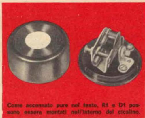
Il diodo D1 impedisce il passaggio della corrente con le luci spente e l'accensione accesa; quando invece le luci sono accese e l'accensione è spenta, un terminale del cicalino è collegato a massa attraverso la bassa resistenza del sistema d'accensione, D1 viene polarizzato nel senso di conduzione dalla batteria ed il cicalino suona. Per le auto con batteria da 6 V si elimina R1 ed in quelle con positivo a massa si invertono i collegamenti del segnalatore. ★
