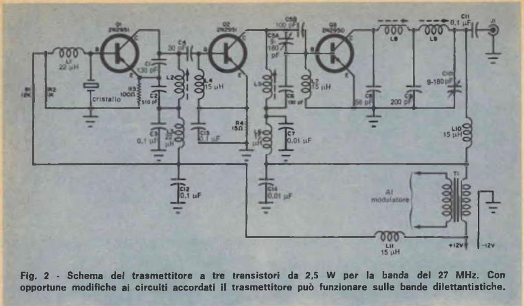
**Fig. 2 - Schema del trasmettitore a tre transistori da 2,5 W per la banda dei 27 MHz. Con opportune modifiche ai circuiti accordati il trasmettitore può funzionare sulle bande dilettantistiche.**
