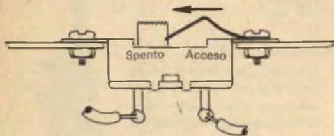
Se vi occorre un interruttore a pulsante e disponete soltanto di un tipo a slitta, piegate a forma di V un pezzo di molla, praticate in esso un foro per poterlo sistemare sotto una vite di fissaggio dell'interruttore e montate il tutto come illustrato. Per trattenere a posto la molla fate un piccolo intaglio nella levetta dell'interruttore. Con questo sistema si può improvvisare un interruttore normalmente aperto oppure normalmente chiuso.
