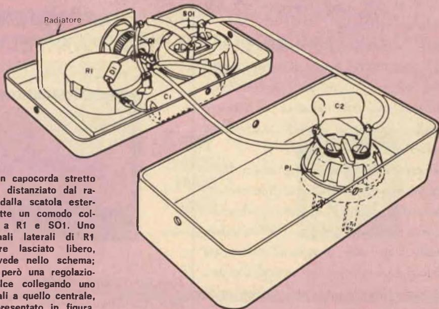
Fig. 4 - Un capocorda stretto a T2 (ben distanziato dal radiatore e dalla scatola esterna) permette un comodo collegamento a R1 e SO1. Uno dei terminali laterali di R1 può essere lasciato libero, come si vede nello schema; si ottiene però una regolazione più dolce collegando uno dei terminali a quello centrale, come rappresentato in figura.
