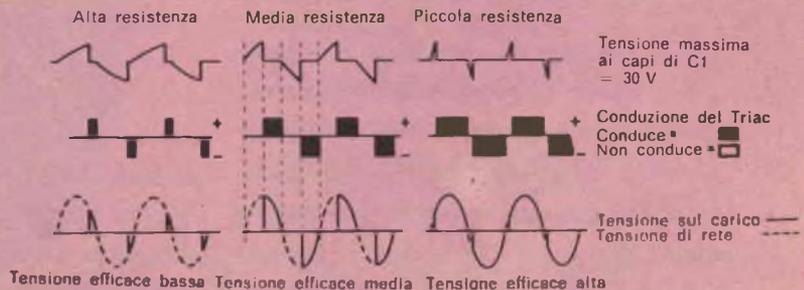
questo diodo "scocca" e fornisce un impulso alla soglia del Triac. Questo va in conduzione, permette il passaggio di tutta la corrente nel carico e cortocircuita il circuito R1-C1. Il diodo D1 continua a condurre fino a che C1 si scarica completamente, e poi va all'interdizione. Il Triac continua a condurre finché la corrente alternata compie il suo ciclo e passa per lo zero.
