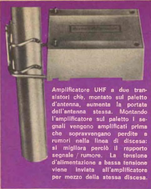
Amplificatore UHF a due transistori che, montato sul paletto d'antenna, aumenta la portata dell'antenna stessa. Montando l'amplificatore sul paletto i segnali vengono amplificati prima che sopravvengano perdite e rumori nella linea di discesa: si migliora perciò il rapporto segnale / rumore. La tensione d'alimentazione a bassa tensione viene inviata all'amplificatore per mezzo della stessa discesa.
