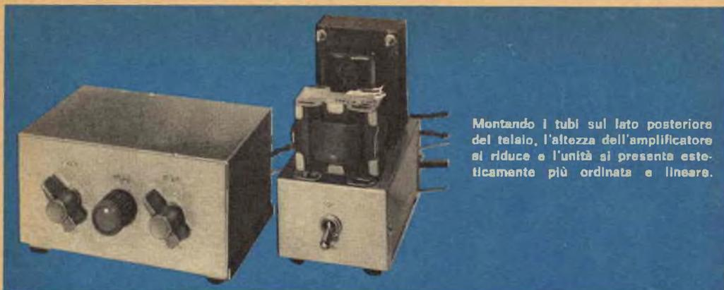
Montando i tubi sul lato posteriore del telaio, l'altezza dell'amplificatore si riduce e l'unità si presenta esteticamente più ordinata e lineare.
