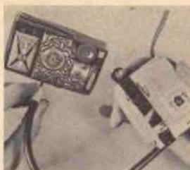
Aggiungendo un alberino flessibile munito di un'adatta punta da taglio ad un vecchio rasoio elettrico, potrete trasformarlo in un comodo attrezzo da taglio o per pulire. Con una staffetta fissate al corpo del rasoio
