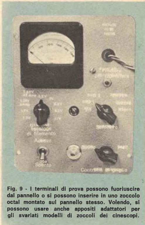
**Fig. 9 - I terminali di prova possono fuoriuscire dal pannello o si possono inserire in uno zoccolo octal montato sul pannello stesso. Volendo, si possono usare anche appositi adattatori per gli svariati modelli di zoccoli dei cinescopi.**
