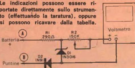
Per completare i collegamenti occorrono soltanto due terminali uno connesso alla batteria, l'altro connesso alle puntine di accensione.
