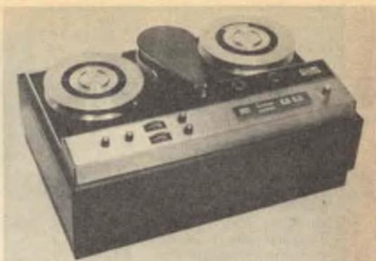
Ecco il nuovo registratore video della Ampex a scansione elicoidale il quale è in grado di registrare anche segnali televisivi a colori.
