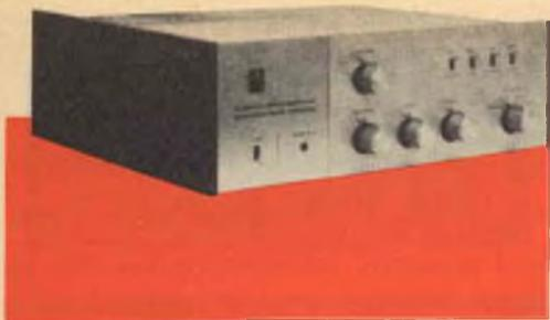
a bassa impedenza, possono inviare la loro uscita direttamente all'altoparlante. Non necessitando del trasformatore d'uscita, i transistori consentono di aggirare uno dei principali ostacoli che si presenta a chi vuole ottenere una buona fedeltà. Come risultato si ottiene dagli apparecchi transistorizzati ad alta fedeltà un suono migliore e più chiaro di quello dei precedenti tipi a valvole.
