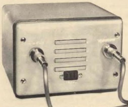
**Fig. 4 - Disponendo nella parte posteriore i connettori di uscita e di entrata del ricevitore e del trasmettitore, come illustrato nella foto, si conferisce all'insieme un aspetto professionale.**
