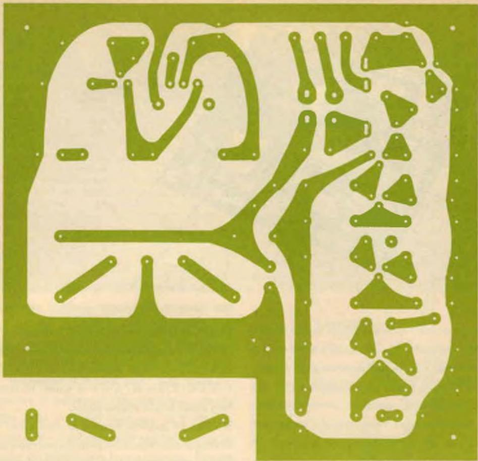
**Fig. 2 - Ecco il circuito stampato nelle sue dimensioni naturali. I componenti si possono montare anche su un telaietto badando però che non si verifichino perdite od accoppiamenti.**
