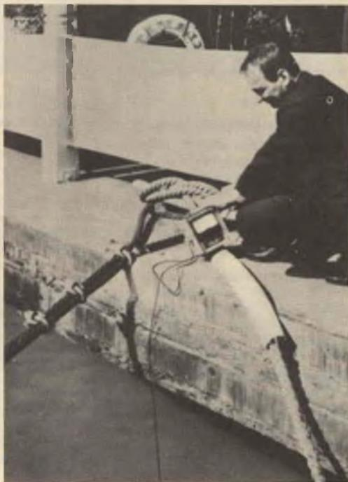
**Il potenziale elettrico dello scafo di acciaio viene misurato ogni mese. Viti prigioniere brasate allo scafo consentono un saldo contatto elettrico e letture precise. La quantità di corrente continua richiesta dipende direttamente dall'area dello scafo che è sottoposta all'azione della corrente.**
