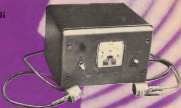
L'apparecchiatura che descriviamo non rappresenta qualcosa di misterioso come può parere a prima vista: si tratta bensì di un semplice fascio di suoni ultrasonici che fa parte di un sistema di allarme, per usi generali, sensibile a tutto e sempre pronto a funzionare. Il sistema può essere usato quale dispositivo antifurto, quale dispositivo anti-incendio o quale dispositivo di controllo e di conteggio in processi industriali. Può anche servire per dimostrare l'uso dei suoni ultrasonici.
