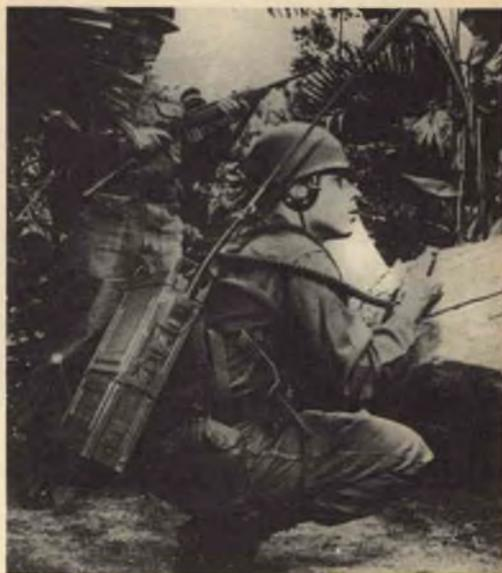
**Il leggero ricetrasmittitore, prodotto dalla Hughes Aircraft Company, può essere trasportato ed usato con facilità da una sola persona. Oltre che con pile a secco ed a liquido, può funzionare, per impianti fissi, con la corrente prelevata da una batteria d'auto, da una linea di alimentazione o da un gruppo elettrogeno portatile.**
