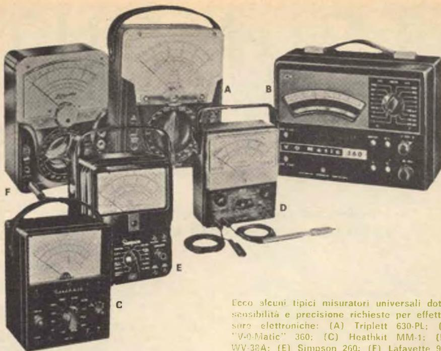
Ecco alcuni tipici misuratori universali dotati della sensibilità e precisione richieste per effettuare misure elettroniche: (A) Triplet 630-PL; (B) B&K "V-0-Matic" 360; (C) Heathkit MM-1; (D) RCA WV-38A; (E) Simpson 260; (F) Lafayette 99 R 5004.
