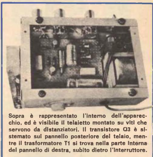
Sopra è rappresentato l'interno dell'apparecchio, ed è visibile il telaio montato su viti che servono da distanziatori. Il transistor Q3 è sistemato sul pannello posteriore del telaio, mentre il trasformatore T1 si trova nella parte interna del pannello di destra, subito dietro l'interruttore.
