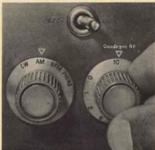
Le letture della maggior parte dei misuratori di intensità dipendono dalla regolazione del controllo di guadagno. In quasi tutti i ricevitori di radioamatori il controllo va ruotato al massimo.
