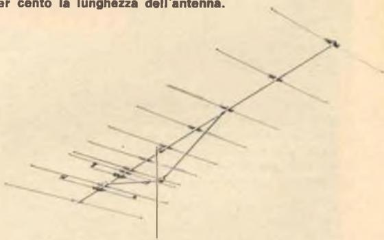
Quest'antenna di tipo Yagi è stata progettata appositamente per migliorare la ricezione di segnali MF stereo in zone con molte interferenze.
