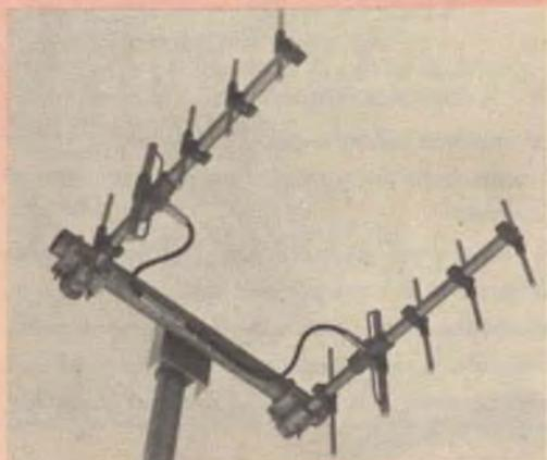
Antenna UHF tipo Yagi con incorporato un balun isolato che ha la funzione di fornire un sistema di alimentazione; in tal modo gli elementi d'antenna alimentati direttamente possono essere sostenuti da elementi metallici anziché da isolatori.
