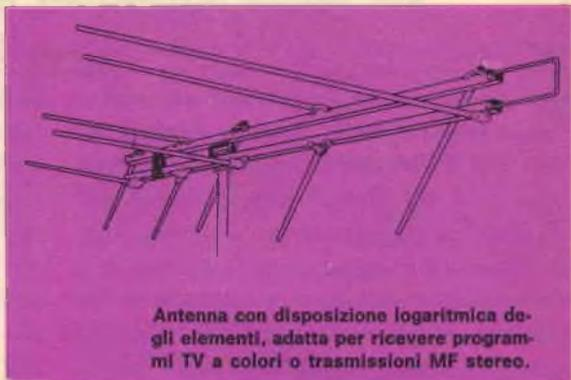
**Antenna con disposizione logaritmica degli elementi, adatta per ricevere programmi TV a colori o trasmissioni MF stereo.**
