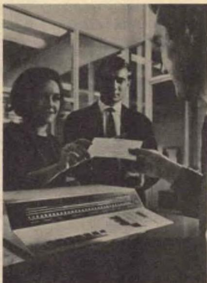
La foto illustra un posto del sistema di prenotazione Siemens Sierra che, funzionando con un centro di elaborazione di dati attraverso linee telegrafiche, permette la prenotazione automatica di posti e biglietti presso le ferrovie spagnole.
