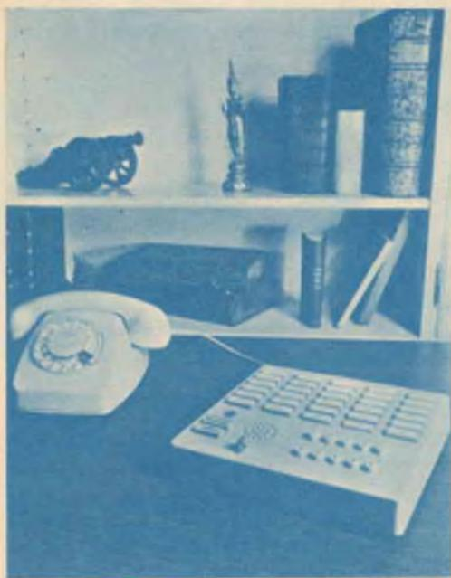
il tasto corrispondente. I numeri di chiamata, che possono comprendere fino a sedici cifre, vengono memorizzati elettronicamente e si possono modificare con facilità con l'aiuto della sola tastiera, senza dover eseguire saldature. L'apparecchio possiede inoltre una tastiera di selezione costituita da dieci tasti con cifre, che può essere utilizzata al posto del disco combinatore convenzionale per la formazione
