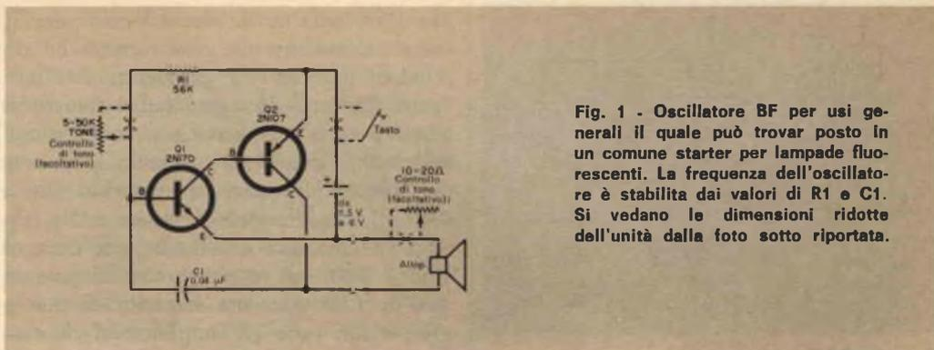
Fig. 1 - Oscillatore BF per usi generali il quale può trovar posto in un comune starter per lampade fluorescenti. La frequenza dell'oscillatore è stabilita dai valori di R1 e C1. Si vedano le dimensioni ridotte dell'unità dalla foto sotto riportata.
