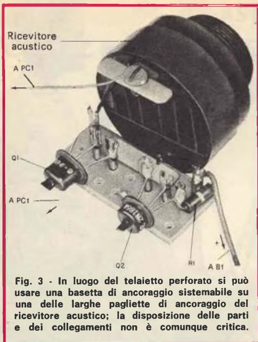
**Fig. 3 -** In luogo del telaio perforato si può usare una bassetta di ancoraggio sistemabile su una delle larghe pagliette di ancoraggio del ricevitore acustico; la disposizione delle parti e dei collegamenti non è comunque critica.
