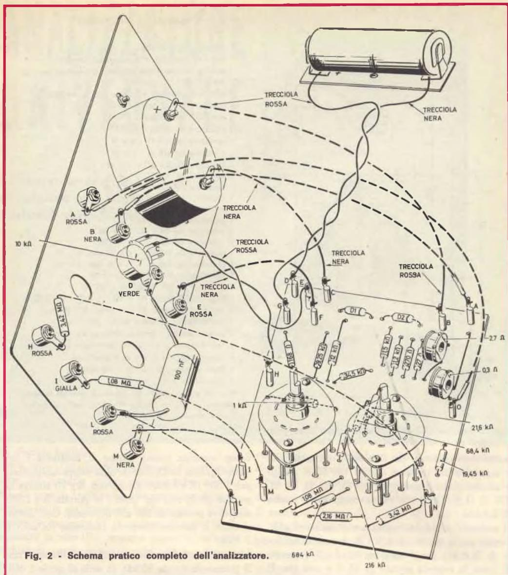
Fig. 2 - Schema pratico completo dell'analizzatore.
