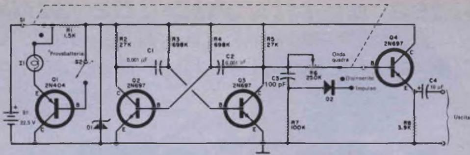
Fig. 1 - Questo calibratore per oscilloscopio è in essenza un generatore ad onda quadra; esso produce anche un impulso ad andamento positivo che serve per effettuare varie prove. Le condizioni della batteria sono controllate per mezzo della lampada di prova (I1) inserita nel circuito di Q1.
