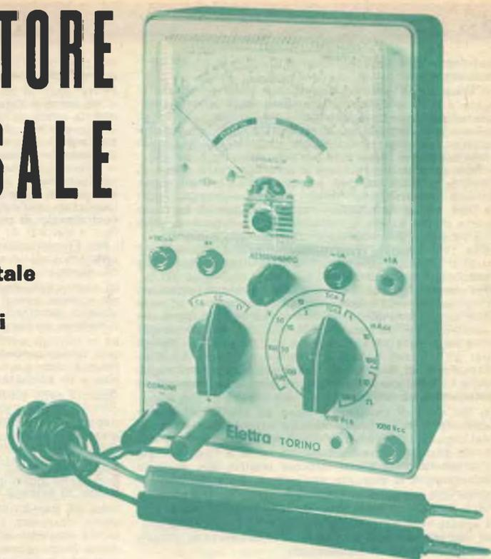
**N**el presente articolo proponiamo ai lettori la costruzione di un analizzatore universale da 10.000  $\Omega/V$ , il cui montaggio può essere effettuato con discreta facilità.
