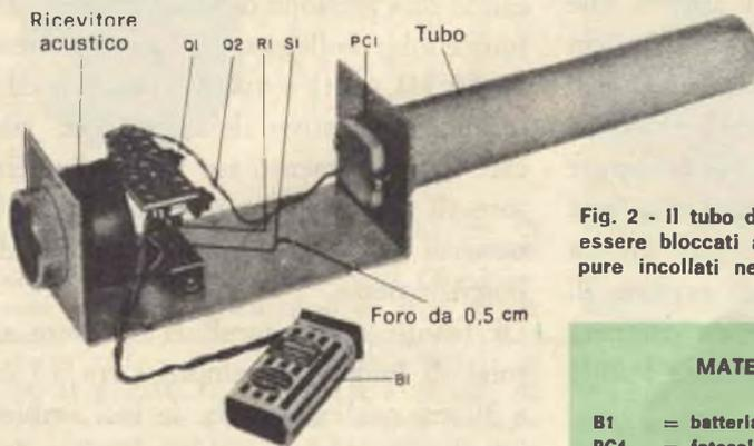
**Fig. 2** - Il tubo di cartone e la fotocellula possono essere bloccati al loro posto mediante staffe, oppure incollati nella loro sede con colla comune.
