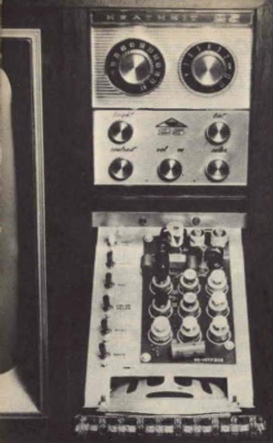
In questa figura le tavolette a circuito stampato ed il complesso di uscita orizzontale sono presentati montati su un telaio verticale estraibile dall'apparecchio; detto telaio è incernierato sul lato sinistro di una chiusura magnetica che ha la funzione di isolare il cinescopio da campi magnetici esterni. Quando il telaio è aperto, tutti i punti di prova ed i terminali sono facilmente accessibili, il che semplifica le operazioni di revisione e quelle di manutenzione.
