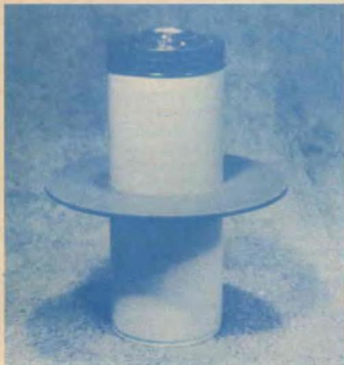
Questo tubo dall'aspetto innocuo è un efficiente sistema d'allarme; è sufficiente che esso cada perché emetta un suono rauco e prolungato. Il segreto consiste in un commutatore al mercurio.
