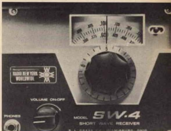
Il funzionamento del ricevitore modello SW-4 è semplificato dall'uso di un codice a colori. Il controllo "range peak" è in realtà un preselettore RF; la linea colorata sul pannello serve per accoppiare i colori analoghi degli altri due controlli.
