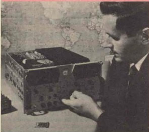
Questo ricevitore "Omega" miniatura, in cui sono montati microcircuiti transistorizzati fabbricati dai laboratori della ITT, consente alle navi di comunicare la loro posizione entro il raggio di 800 m. fino ad una distanza di circa 8.000 km. Il ricevitore verrà installato sulle navi della marina statunitense in navigazione nelle varie parti del mondo.
