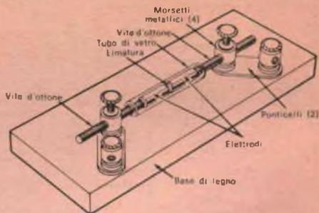
Le parti devono essere montate solidamente su una base di legno. I morsetti metallici a vite faciliteranno la costruzione del complesso ed assicureranno anche buoni collegamenti circuitali.
