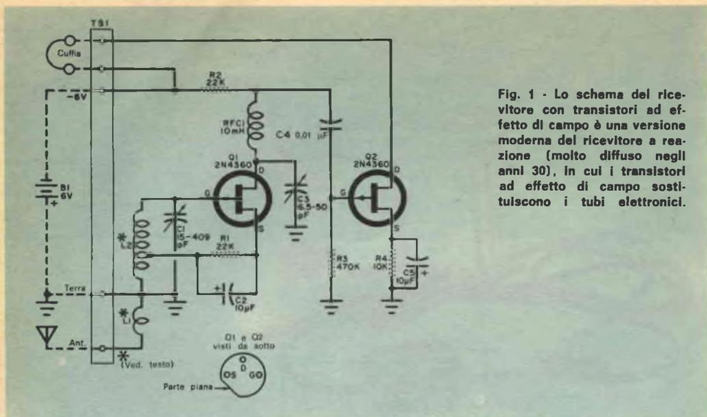
reazione, una parte del segnale che compare sull'elettrodo di scarico (D) di Q1 viene rimandato sulla soglia (G). L'entità della reazione viene controllata da C3. La soglia (G) è autopolarizzata da R1 con in parallelo C2.
