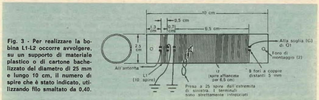
Fig. 3 - Per realizzare la bobina L1-L2 occorre avvolgere, su un supporto di materiale plastico o di cartone bachelizzato del diametro di 25 mm e lungo 10 cm, il numero di spire che è stato indicato, utilizzando filo smaltato da 0,40.
