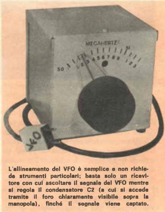
L'allineamento del VFO è semplice e non richiede strumenti particolari; basta solo un ricevitore con cui ascoltare il segnale del VFO mentre si regola il condensatore C2 (a cui si accede tramite il foro chiaramente visibile sopra la manopola), finché il segnale viene captato.
