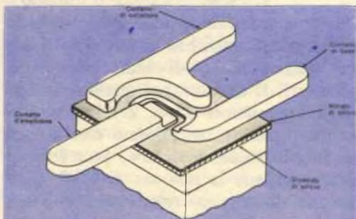
Fig. 1 - Uno strato di nitrato di silicio viene applicato, contemporaneamente alle sbarrette di contatto, ad uno strato di diossido di silicio durante la sigillatura di un dispositivo semiconduttore.
