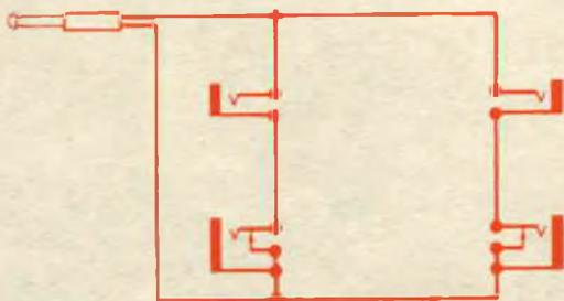
In questo adattatore per ricevitori a transistori possono essere inseriti fino a quattro auricolari. Se si usa un solo auricolare, questo dovrà essere inserito in un jack a circuito aperto; se ne vengono utilizzati due, questi andranno inseriti in due jack qualsiasi; per tre auricolari si lascia libero un jack a circuito chiuso e per quattro auricolari si usano tutti i quattro jack.
