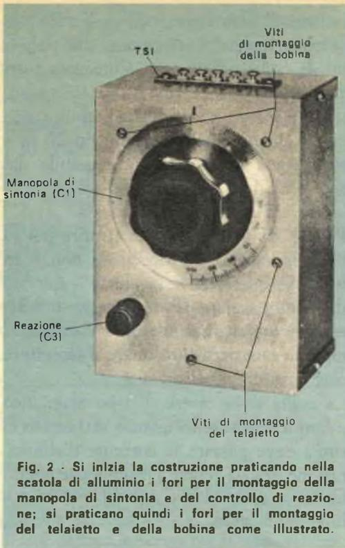
Fig. 2 - Si inizia la costruzione praticando nella scatola di alluminio i fori per il montaggio della manopola di sintonia e del controllo di reazione; si praticano quindi i fori per il montaggio del telaio e della bobina come illustrato.
