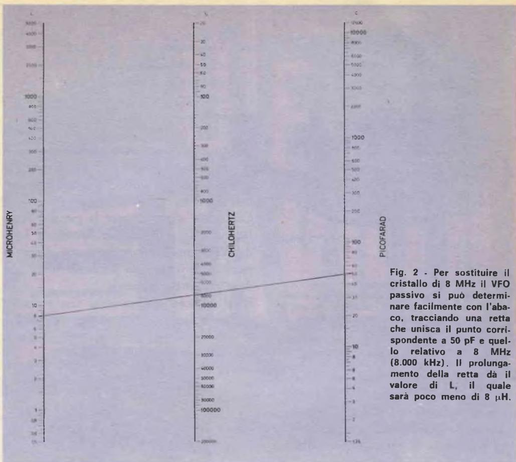
Fig. 2 - Per sostituire il cristallo di 8 MHz il VFO passivo si può determinare facilmente con l'abaco, tracciando una retta che unisca il punto corrispondente a 50 pF e quello relativo a 8 MHz (8.000 kHz). Il prolungamento della retta dà il valore di L, il quale sarà poco meno di 8  $\mu$ H.
