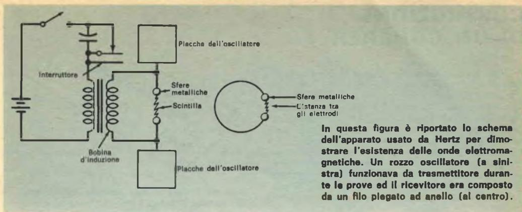
In questa figura è riportato lo schema dell'apparato usato da Hertz per dimostrare l'esistenza delle onde elettromagnetiche. Un rozzo oscillatore (a sinistra) funzionava da trasmettitore durante le prove ed il ricevitore era composto da un filo piegato ad anello (al centro).
