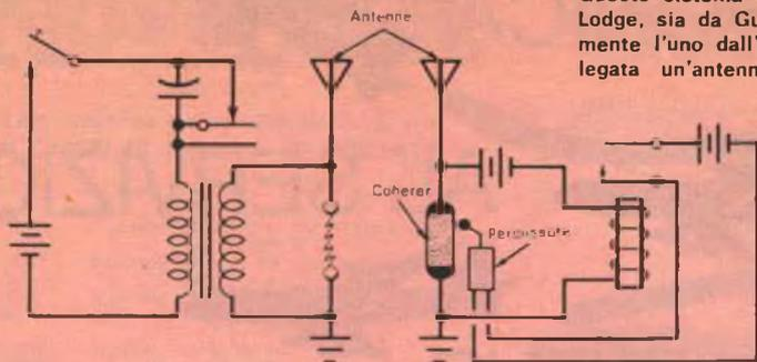
Questo sistema fu progettato sia da sir Oliver Lodge, sia da Guglielmo Marconi, indipendentemente l'uno dall'altro. Al trasmettitore era collegata un'antenna che sostituiva le placche dell'oscillatore usate da Hertz. Il ricevitore era composto da un coherer di Branley, da un dispositivo di percussione di Popov e da un'antenna ricevente. Il funzionamento era essenzialmente uguale a quello dell'apparato di Hertz, ma la sensibilità enormemente aumentata.
