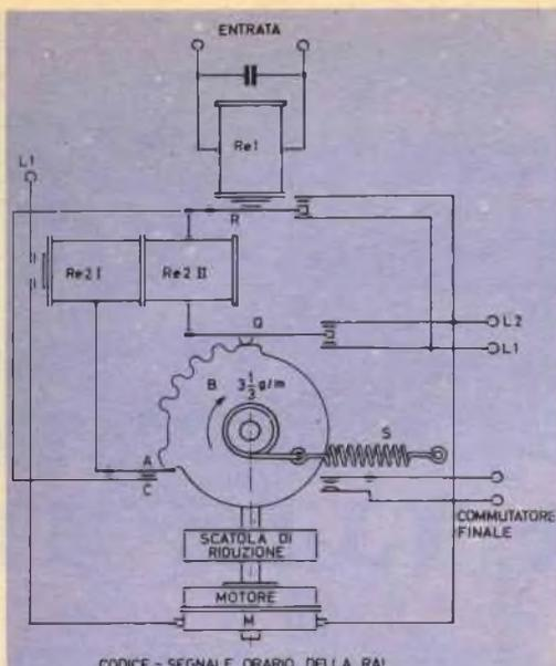
Fig. 2 - Modello a codice intercambiabile.
