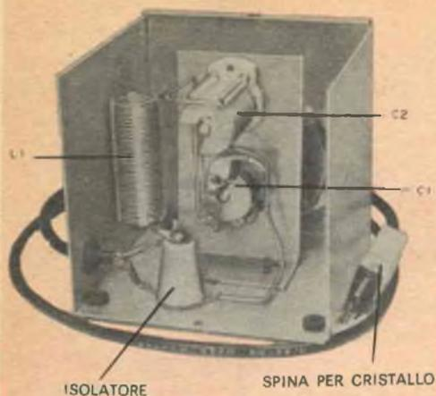
**Fig. 3 -** Le capacità d'accordo sono premontate su una staffa d'alluminio che viene poi fissata sul fondo della scatola. L'isolatore ancora il cavo coassiale che, partendo dalla bobina, va alla spina per il cristallo del trasmettitore.
