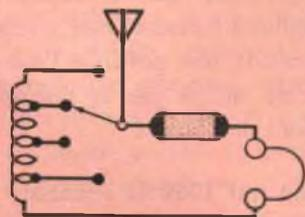
Ecco il circuito per il collegamento del coherer illustrato a sinistra. Per evitare danni alla limatura, è necessario un relé che assorba non più di 60 mA.
