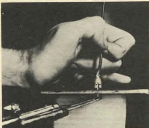
onde evitare cortocircuiti tra il conduttore centrale e lo schermo di un cavetto schermato ed inoltre far sì che lo stagno non coli dentro le spinette jack, si può stagno preventivamente l'interno della punta della spina e tenere rovesciata la spina stessa quando si salda ad essa il cavetto schermato. Per svolgere questa operazione prendete un pezzo di legno sottile e praticate in esso un
