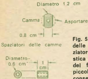
Fig. 5 - Per la costruzione delle camme e degli spaziatori si può usare plastica o fibra. I diametri dei fori devono essere piccoli abbastanza per consentire un montaggio forzato ed evitare slittamenti; lo spessore delle camme non è critico.
