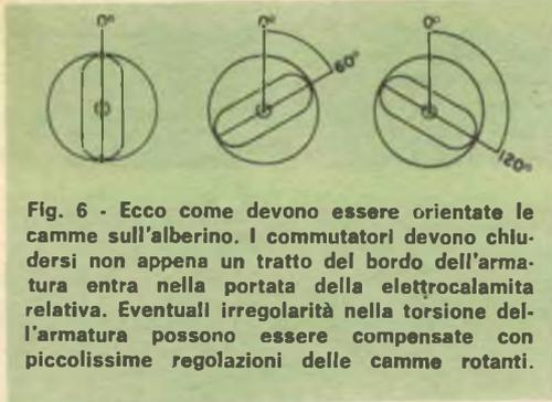
Fig. 6 - Ecco come devono essere orientate le camme sull'alberino. I commutatori devono chiudersi non appena un tratto del bordo dell'armatura entra nella portata della elettrocalamita relativa. Eventuali irregolarità nella torsione dell'armatura possono essere compensate con piccolissime regolazioni delle camme rotanti.
