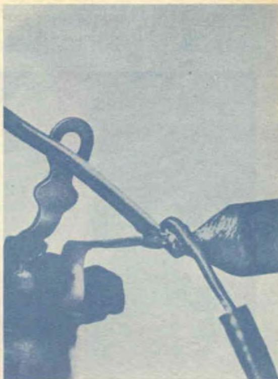
Per ottenere i migliori risultati, il calore e lo stagno devono essere applicati su lati opposti della connessione. Ciò permette allo stagno di scorrere bene dentro ed intorno alla giuntura. Si usi una quantità di stagno appena sufficiente per ottenere una buona e solida connessione.
