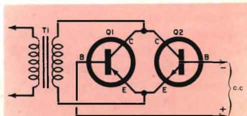
Fig. 5 - Raddrizzatore a ponte con 2 transistori.
