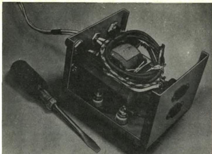
Nella costruzione del prototipo, il trasformatore per filamenti, i due portafusibili ed il gommino per il cordone di rete sono stati montati su un lato della scatola; i morsetti d'uscita sulla parte superiore e le due prese di rete sull'altro lato. La disposizione delle parti e dei collegamenti non è comunque critica, per cui si può adottare qualsiasi altra tecnica.
