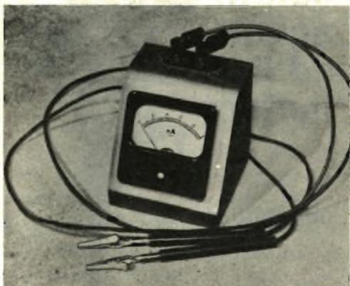
Tutti i componenti si possono montare convenientemente dentro una scatola di opportune dimensioni. Per l'entrata allo strumento si usano adatti connettori, montati nella parte superiore della scatola, come si rileva da questa figura.
