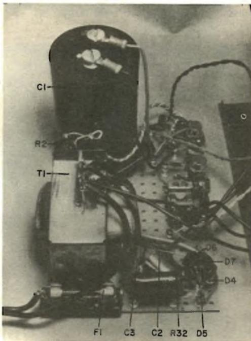
I componenti per la costruzione del temporizzatore si possono disporre come si ritiene più opportuno. Per il montaggio del prototipo è stato usato, come telaio, un pezzo di laminato perforato, perché tutto il circuito è stato racchiuso in un mobiletto metallico di dimensioni adatte.
