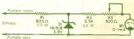
Il diodo zener D1 è il componente principale del circuito misuratore di pausa; il potenziometro R3 viene usato per effettuare la taratura.
