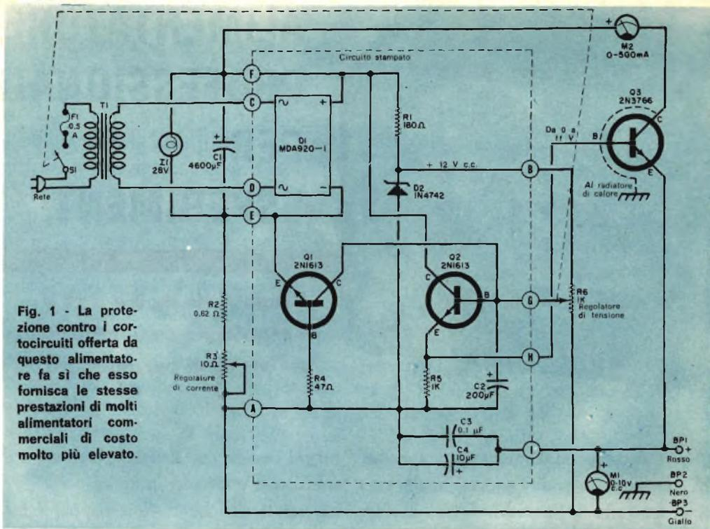
Fig. 1 - La protezione contro i cortocircuiti offerta da questo alimentatore fa sì che esso fornisca le stesse prestazioni di molti alimentatori commerciali di costo molto più elevato.
