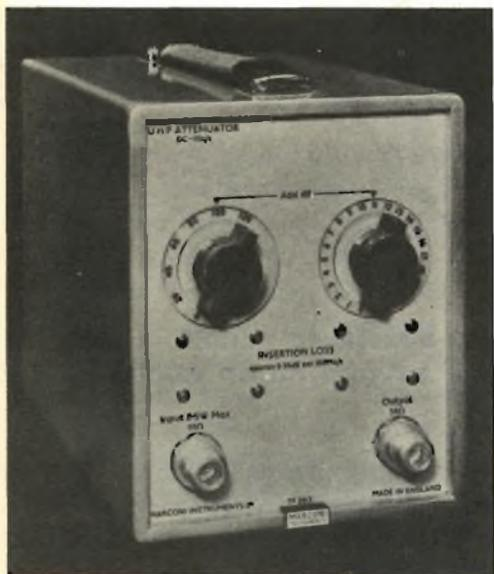
**N**ella fotografia è illustrato l'attenuatore "TF 2163" costruito dalla ditta Marconi, il quale opera in UHF con impedenza caratteristica di 50  $\Omega$  e gamma di attenuazione di 142 dB.
