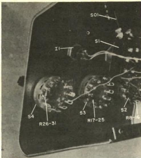
I resistori di tempo si saldano direttamente ai terminali dei commutatori rotanti S2, S3 e S4; se si usano resistori con tolleranza del 5%, si tagliano i fili corti e, nell'effettuare le saldature, si eviti di applicare un calore eccessivo.
