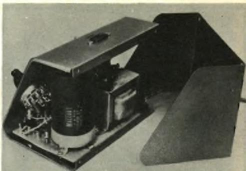
Il temporizzatore è stato racchiuso in una scatola metallica con pannello inclinato, nella quale si è inserito il telaio di materiale fenolico perforato, distanziandolo dal fondo mediante distanziatori di materiale isolante. Le misure della scatola sono determinate soprattutto dalle dimensioni del condensatore C1 che è impiegato.
