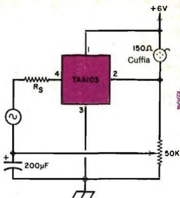
Questo minuscolo amplificatore ad alto guadagno per cuffia ha un guadagno di 70 dB dalla c.c. a 600 kHz. Il volume si regola mediante un potenziometro da 50 k $\Omega$ . Il resistore  $R_S$  deve avere un valore di 1.000  $\Omega$  oppure inferiore; può essere aggiunto un trasformatore per pilotare cuffie ad alta impedenza.
