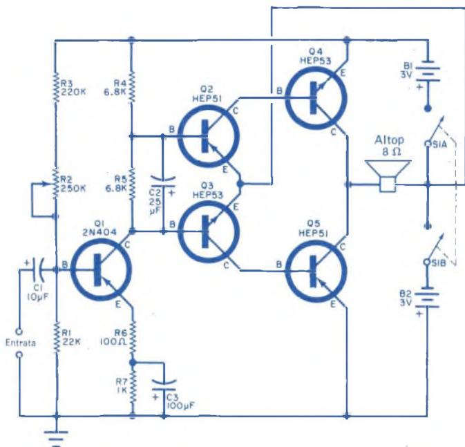
**Fig. 1** - Questo amplificatore da 0,5 W ha un guadagno di 67 dB, ed un responso in frequenza da 16 Hz a più di 60 kHz. Quattro pile da 1,5 V grandi collegate in serie forniscono l'alimentazione per molte ore di funzionamento.
