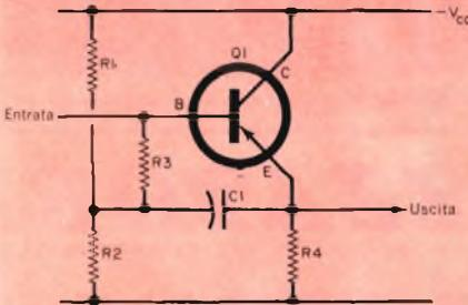
Come si vede nello schema qui riportato, denominato appunto « circuito autocompensatore », R1 e R2 formano un partitore di tensione per la polarizzazione di base mentre R3 è un resistore di isolamento collegato tra la base del transistor ed il punto di unione tra R1 e R2. Il segnale d'entrata viene introdotto nella base del transistor e l'uscita, prelevata ai capi del resistore d'emettitore R4, è anche accoppiata a R3 attraverso il condensatore C1.
