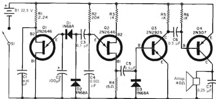
visibile l'apparecchio a montaggio ultimato. L'oscillatore generatore di nota (Q2) è un transistor ad unigiunzione, i cui elementi determinanti la frequenza (C4 e C3) sono introdotti nel circuito in concordanza con il funzionamento dell'oscillatore ausiliario Q1, anch'esso ad unigiunzione. Il segnale d'uscita, la cui frequenza cresce rapidamente finché Q1 non conduce per riportare tale segnale ad una nota di frequenza molto bassa, viene amplificato da Q3 e dal transistor di potenza Q4.
