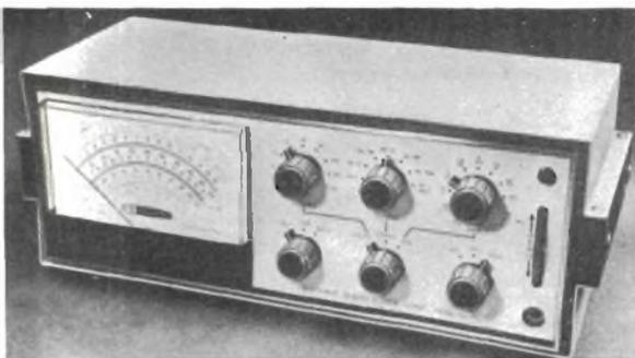
Nel modello IM-25 della Heath vengono usate quattordici pile  $\varnothing$  26 x 49 mm, due per la funzione dell'ohmmetro e le altre dodici per l'alimentazione. Questo strumento può, se occorre, essere anche alimentato a rete.
