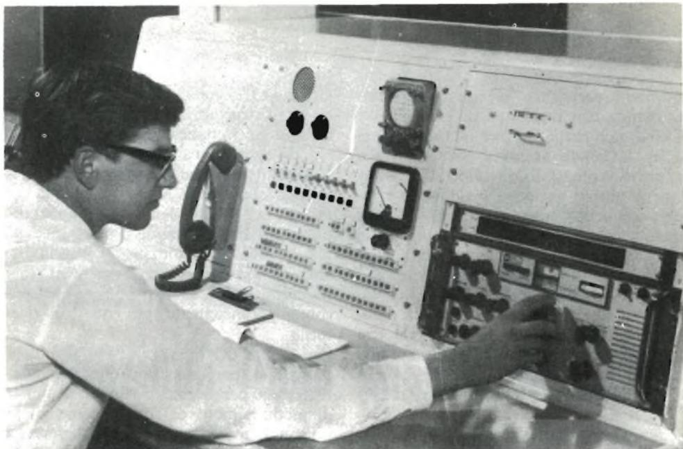
Fig. 2 - Banco di controllo del dirigente in servizio, il quale sta regolando il ricevitore per comunicazioni PR 1550 costruito dalla ditta Plessey, dotato di un indicatore numerico della frequenza.
