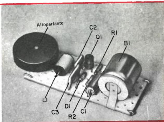
cauzioni per i collegamenti, il circuito può essere montato come si preferisce. Nel montaggio illustrato nella *fig. 2* si è usato un telaio di materiale fenolico perforato; si può però adottare qualsiasi altro sistema. Il dispositivo, insieme alle batterie ed all'altoparlante, può essere racchiuso in una scatola metallica.
