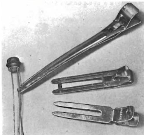
Le pinzette che le signore usano per puntare i capelli, servono ottimamente come radiatori di calore. Esistono diversi tipi di queste pinzette, sia come forma sia come dimensione. Alcune hanno ampie ganasce e vanno bene per dissipare molto calore, altre hanno punte molto sottili e talvolta ripiegate, e si possono inserire facilmente nei punti più scomodi di un telaio. Tre o quattro differenti tipi di simili pinzette basteranno per tutti gli scopi.
