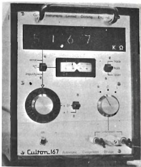
Fig. 1 - Ponte di misura automatico Culton.
