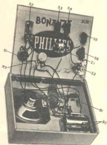
I controlli e le lampadine si possono montare opportunamente sul coperchio di una scatola da sigari e gli altri componenti sul fondo. Dopo il montaggio dell'altoparlante, occorre fissare sotto la scatola piedini di gomma in modo da consentire al suono di uscire liberamente.
