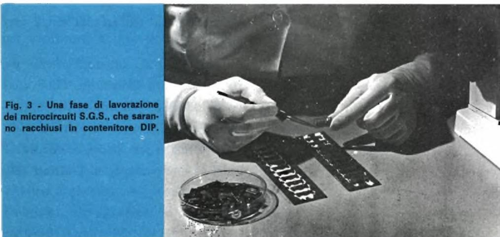
**Fig. 3 - Una fase di lavorazione dei microcircuiti S.G.S., che saranno racchiusi in contenitore DIP.**
