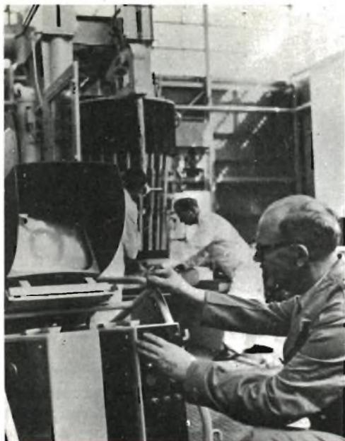
**Sistema a circuito chiuso realizzato dalla Pye Laboratory Ltd., usato per ispezionare i canali di caricamento nei quattro reattori di una centrale elettro-nucleare. A destra vi è il meccanico per far scendere la telecamera nel reattore.**
