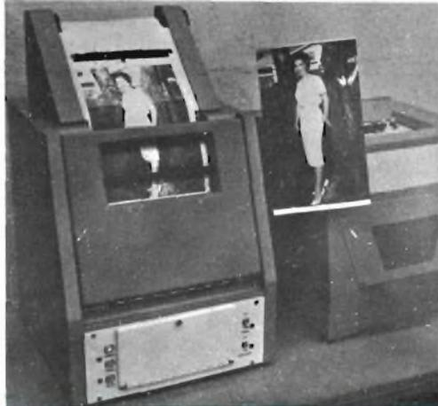
In apparecchi delle dimensioni di una comune scatola, sistemi fax normali registrano una fotografia inserita a destra e riprodotta a sinistra.
