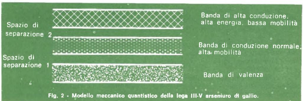
Fig. 2 - Modello meccanico quantistico della lega III-V arseniuro di gallio.
