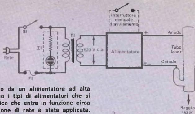
Fig 2 - L'apparato è composto da un alimentatore ad alta tensione e dal laser. Due sono i tipi di alimentatori che si possono usare: quello automatico che entra in funzione circa un secondo dopo che la tensione di rete è stata applicata, e quello di tipo manuale con un interruttore di avviamento.
