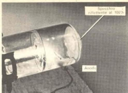
All'estremità di anodo del tubo laser, lo specchio è riflettente al 100% per evitare che il raggio luminoso possa sfuggire da quel lato.
