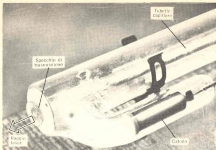
**Particolare dell'estremità di uscita del laser. Si noti che per fissare il tubo al suo posto sono state usate staffe per condensatori elettrolitici. Si faccia attenzione che le parti ottiche d'uscita siano pulite e che il laser sia montato con rigidità sulla scatola.**
