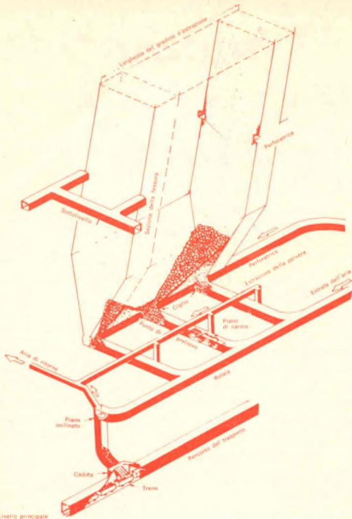
Ecco uno dei sistemi di estrazione e di trasporto usati. Il minerale spezzato cade sul fondo del gradino d'estrazione, viene tolto a mezzo di un caricatore e scaricato nel piano inclinato. Quindi, il minerale scende e subito dopo è caricato sui treni.
