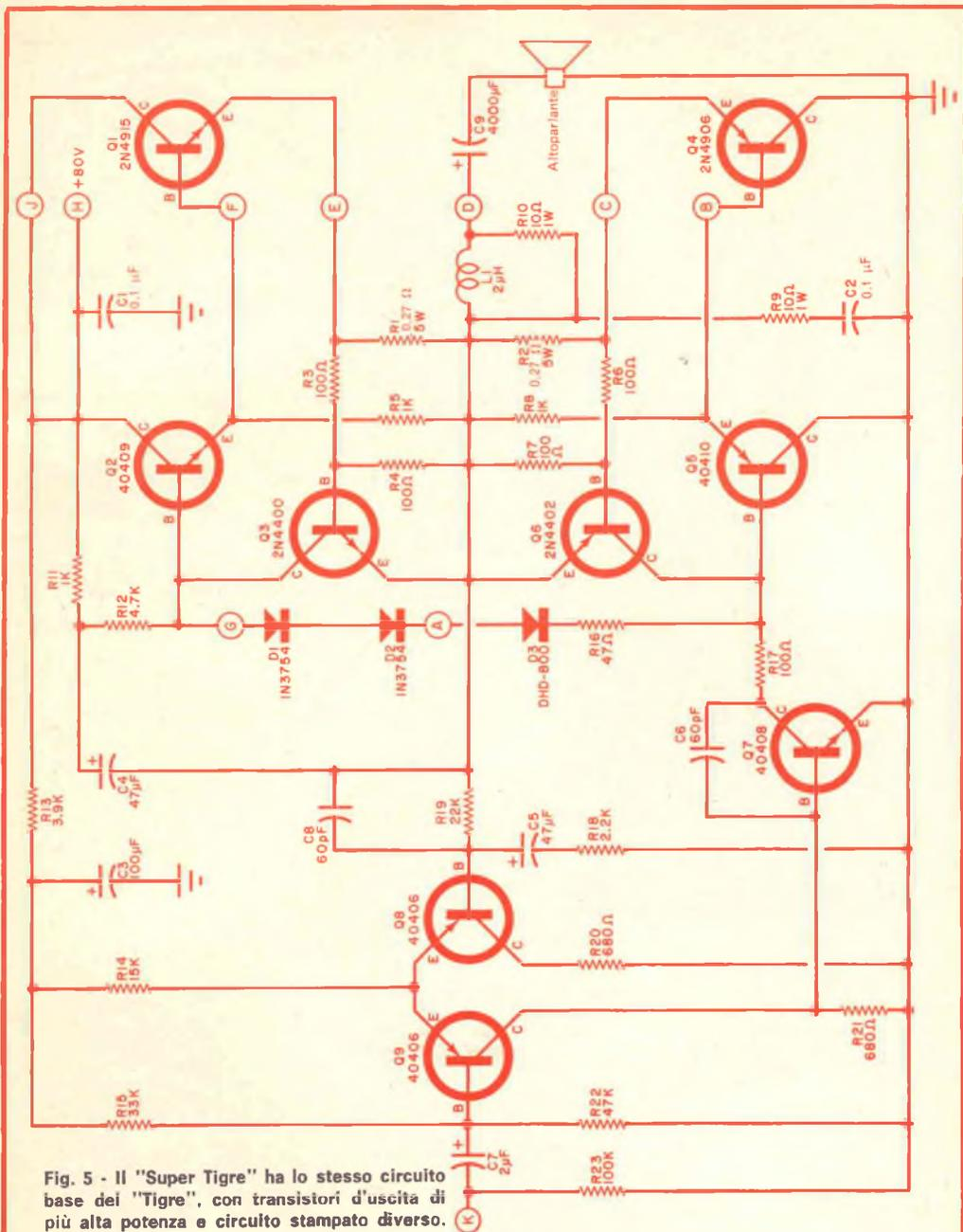
Fig. 5 - Il "Super Tigre" ha lo stesso circuito base del "Tigre", con transistori d'uscita di più alta potenza e circuito stampato diverso.
