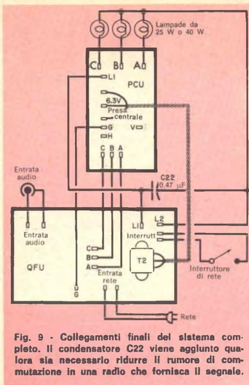
Fig. 9 - Collegamenti finali del sistema completo. Il condensatore C22 viene aggiunto qualora sia necessario ridurre il rumore di commutazione in una radio che fornisca il segnale.
