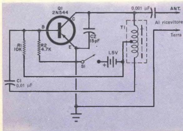
**Fig. 1** - Questo BFO esterno dovrebbe essere utile a molti ascoltatori che posseggono ricevitori non previsti per l'ascolto delle trasmissioni in codice Morse. I terminali d'uscita vanno direttamente al ricevitore ad onde corte.
