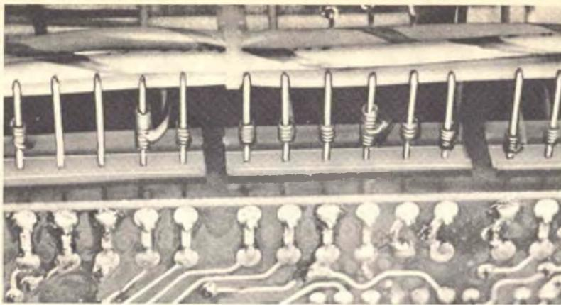
**Negli apparecchi Scott viene usata la tecnica di collegamento dei fili avvolti. Un utensile speciale avvolge strettamente il filo intorno ad uno spinotto metallico quadro, ottenendo un collegamento elettrico superiore all'ordinaria saldatura.**
