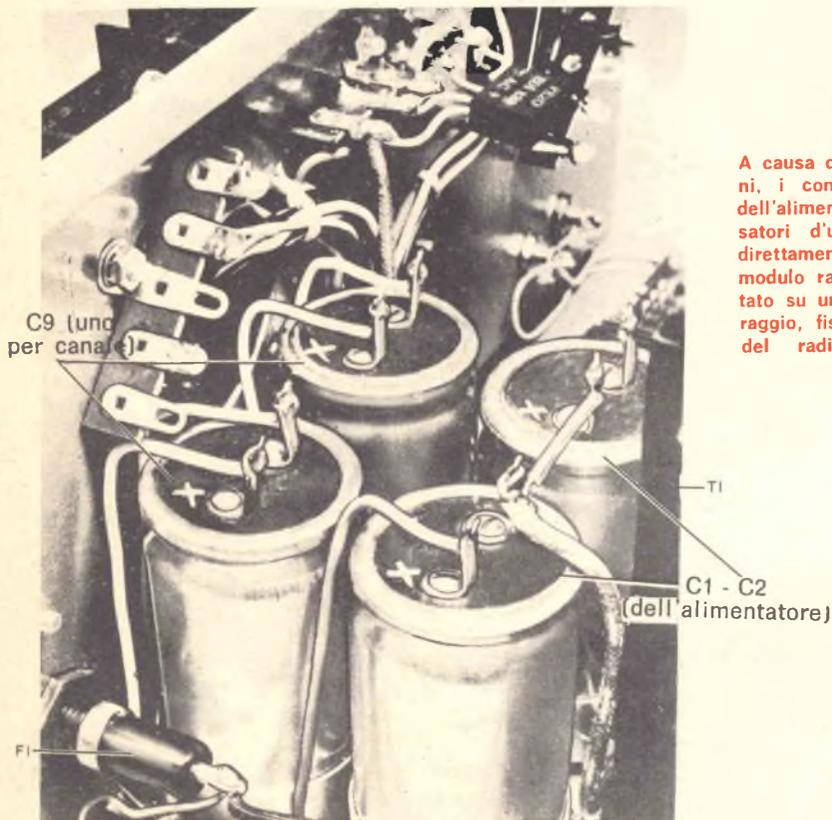
A causa delle loro dimensioni, i condensatori di filtro dell'alimentatore ed i condensatori d'uscita si montano direttamente sul telaio. Il modulo raddrizzatore è montato su una basetta di ancoraggio, fissata con una vite del radiatore di calore.
