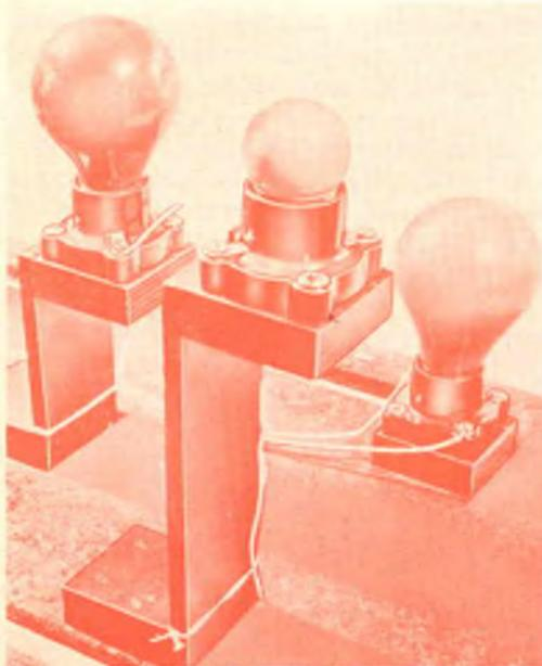
I colori relativi ad ogni canale dipendono dal gusto personale. Ottenuto il funzionamento del sistema, si possono cambiare i colori spostando i collegamenti ai terminali ad aletta. Prima di toccare questi terminali occorre spegnere l'apparato. Il sistema non ha un tempo di riscaldamento e perciò non è necessario affrettarsi.
