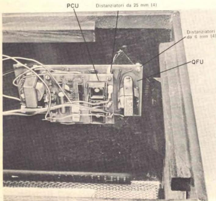
**Fig. 8** - Per fissare insieme i circuiti stampati del PCU e del QFU si usano quattro distanziatori da 25 mm. Con piccoli distanziatori si fissa poi l'insieme nella parte superiore del mobile, con i cursori dei potenziometri accessibili attraverso un taglio praticato nell'apposito pannello.
