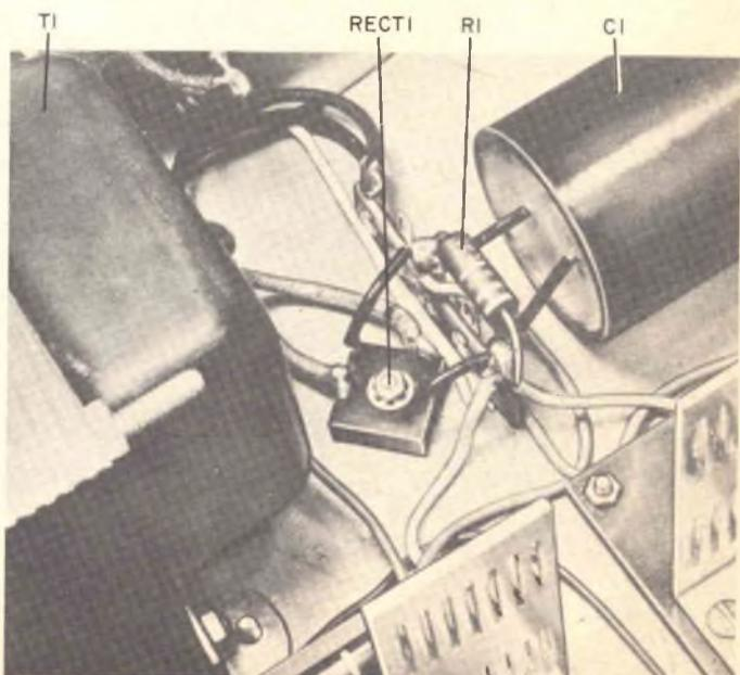
Particolare dell'alimentatore. Il modulo raddrizzatore è avvitato al telaio ed i collegamenti sono fatti tramite una basetta d'ancoraggio.
