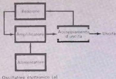
**Fig. 1 - Il laser è essenzialmente una varietà di oscillatore, in quanto in esso sono presenti sia un amplificatore sia un meccanismo di reazione. Nel laser, parte del circuito di reazione forma anche l'accoppiamento d'uscita. In pratica, tutto è fatto con specchi speciali alle estremità del tubo.**
