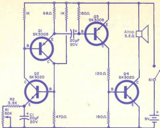
re, questo circuito può essere usato con qualsiasi ricevitore supereterodina con frequenza intermedia di 455 kHz.
