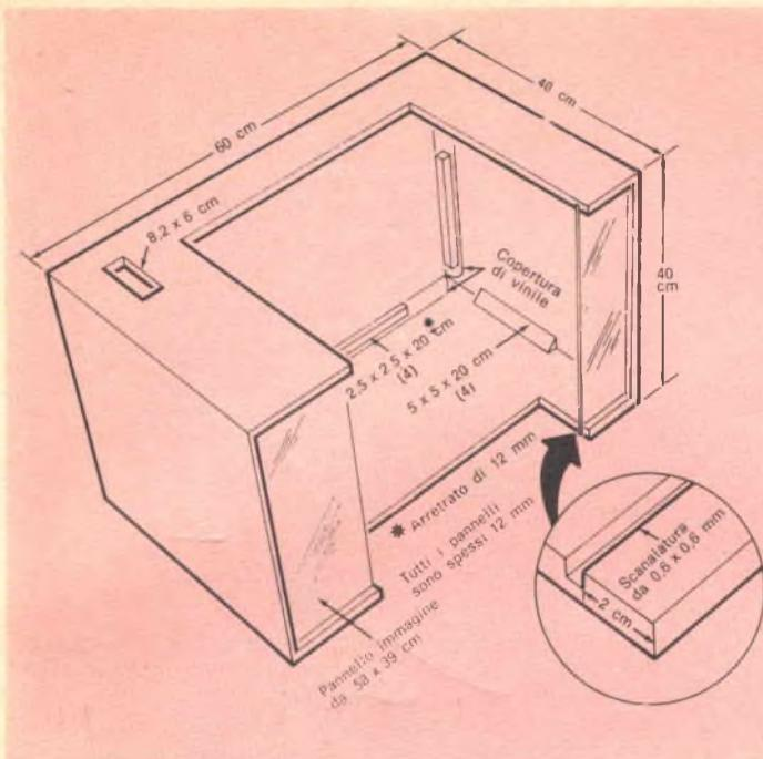
**Fig. 10** - Particolari costruttivi generici del mobile di presentazione, per il quale si possono adottare dimensioni diverse. I controlli sono accessibili attraverso un'apertura praticata nella parte superiore del mobile. Questo si può disporre sia in senso orizzontale, sia in senso verticale.
