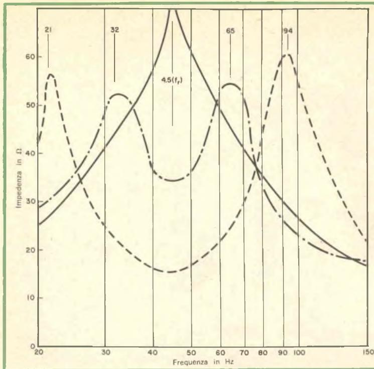
Fig. 1 - Il grafico a sinistra mostra l'impedenza dell'altoparlante all'aria libera (linea continua), l'impedenza in un mobile accordato da 21 dm<sup>3</sup> (linea tratteggiata) e l'impedenza in un mobile accordato da 140 dm<sup>3</sup> (indicata con punti e linee).
