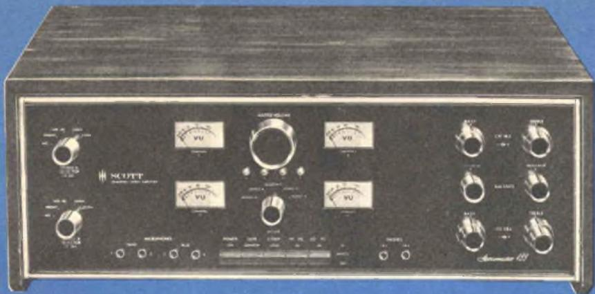
L'amplificatore "Quadrant" della ditta H. H. Scott ha un'uscita di 35 W efficaci per canale su 8  $\Omega$ . È dotato di circuiti preamplificatori integrati e di uscite complementari accoppiate direttamente senza condensatori; il prezzo di tale apparecchiatura è molto elevato.
