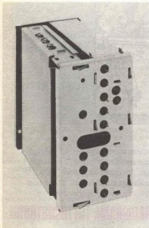
Tuner Varicap UHF/VHF della serie F24, che rende inutile il comando meccanico diretto dalla parte frontale del televisore; è realizzato dalla S.A. Videon.
