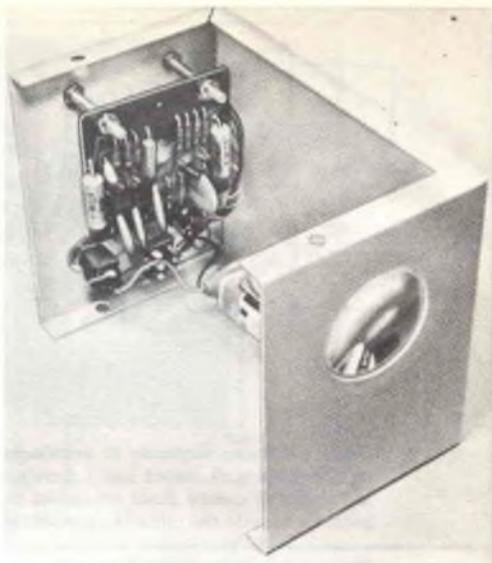
Il ricevitore si monta analogamente al trasmettitore, con la finestra di Q1 sul piano focale della lente. Ottenuto il fuoco, per evitare spostamenti del circuito stampato si possono far colare alcune gocce di collante sulle viti, le quali bloccheranno tutto l'insieme.
