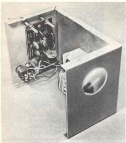
Montando il trasmettitore, si sistemano il circuito stampato e si fissa la lente in modo che la finestra del LED sia sulla linea centrale della lente. Nel testo viene spiegato come regolare il circuito stampato onde focalizzare la lente sulla finestra del diodo D1.
