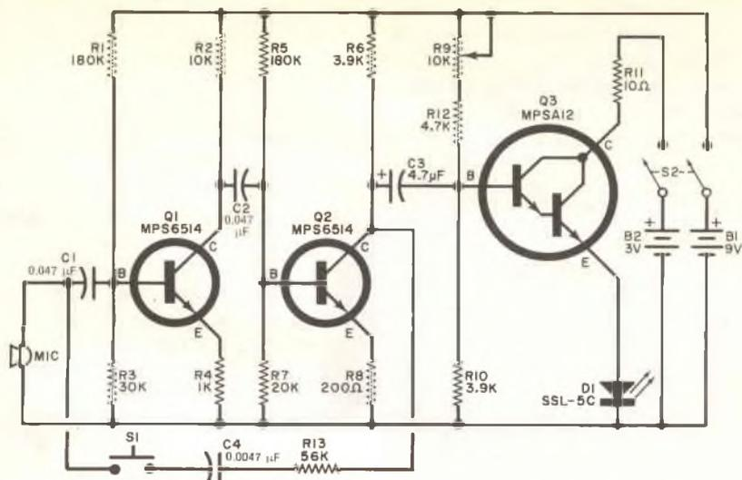
Fig. 1 - Il trasmettitore con LED è composto da un amplificatore audio a due stadi, che pilota un modulatore Darlington. Premendo S1, l'amplificatore viene convertito in un oscillatore audio, che viene usato per mettere a punto il percorso ottico.
