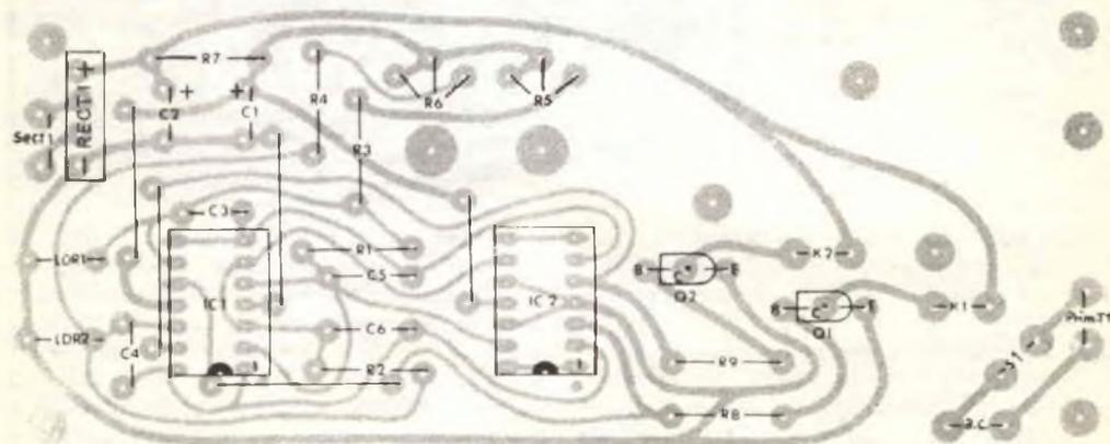
Fig. 2 - Sopra sono riportati, in grandezza naturale, il tracciato per l'incisione ed il piano di foratura del circuito stampato. Nel disporre i componenti occorre fare particolare attenzione all'orientamento dei circuiti integrati e dei componenti con polarizzazione ben definita (figura in basso).
