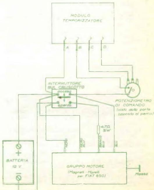
compresi tra 10 V e 16 V. È necessario stare attenti affinché il punto A sia collegato al positivo ed il punto B al negativo della batteria (attraverso il motore).
