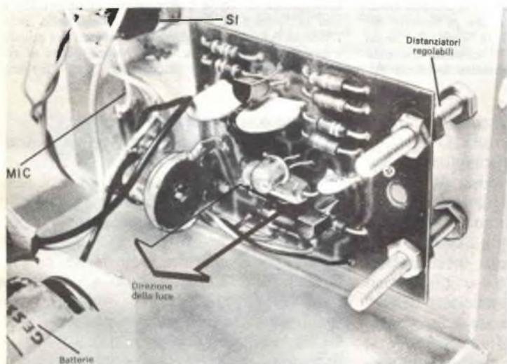
Il trasmettitore si fissa su distanziatori regolabili, in modo che la finestra del LED possa essere portata sul piano focale della lente. Le batterie si montano in posizione da non interrompere il raggio luminoso tra la lente ed il LED. Il microfono è montato sulla scatola; è possibile però usare anche un microfono distante. S2 può essere montato sul microfono come pulsante da premere per parlare. L'interruttore S1 si usa poco e può rimanere montato sulla scatola.
