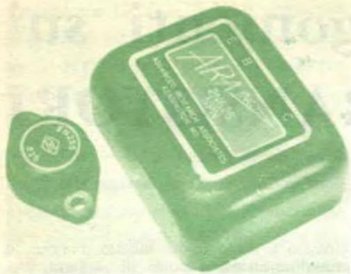
Fig. 2 - La scatola grande conteneva il precursore del dispositivo Darlington TO-5 oggi popolare. Se ne confrontino le dimensioni con quelle del normale transistor di potenza TO-3 visibile qui a sinistra.
