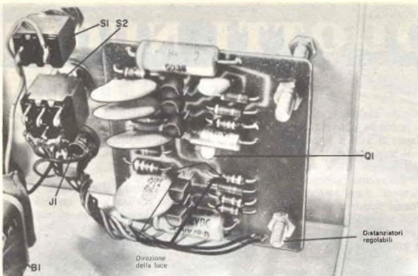
Analogamente al trasmettitore, il circuito stampato del ricevitore si monta su quattro distanziatori regolabili, in modo che la finestra di Q1 sia sul piano focale della lente. In questo caso, si faccia attenzione che le batterie non interrompano il raggio luminoso.
