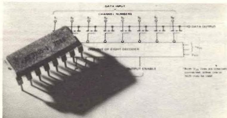
**Fig. 5 - Questo commutatore multiplo della Siliconix può far passare su comando uno tra otto segnali d'entrata. Progettato per circuiti OEM, potrebbe essere adatto per il circuito d'entrata di un oscilloscopio ad otto tracce.**
