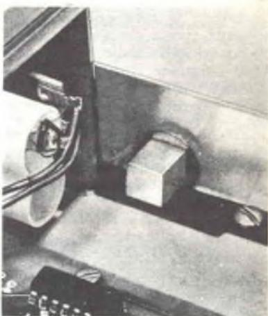
Il contatore di frequenza Heathkit modello IB-101 è costituito da 26 circuiti integrati, 8 transistori, 5 tubi Nixie. I circuiti integrati sono montati su speciali zoccoli. La compattezza del montaggio è notevole e molta cura deve essere posta onde evitare ponticelli di stagno sul circuito stampato. I tubi sono nascosti da uno schermo per la luce visibile (come si vede in alto a sinistra).
