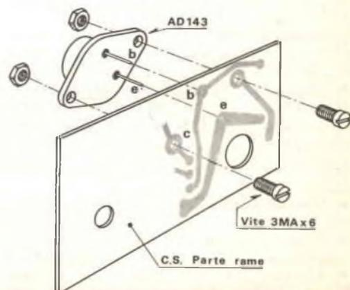
Fig. 4 - Particolare di montaggio del TR3-AD143.
