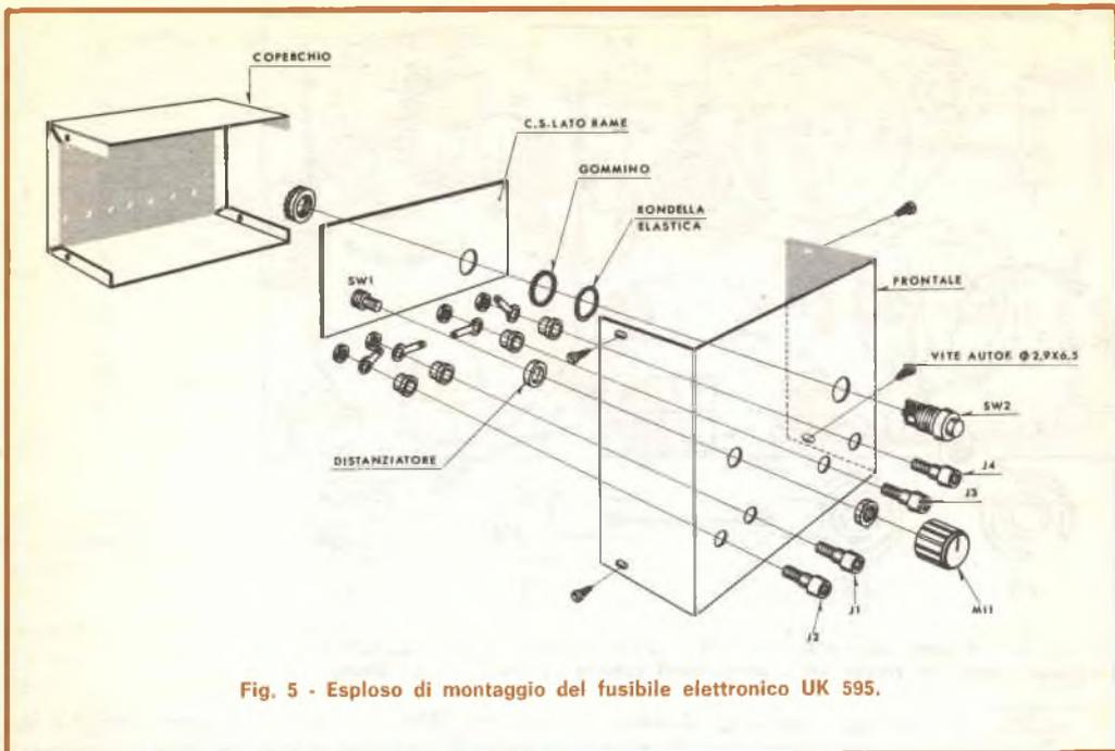
Fig. 5 - Esploso di montaggio del fusibile elettronico UK 595.
