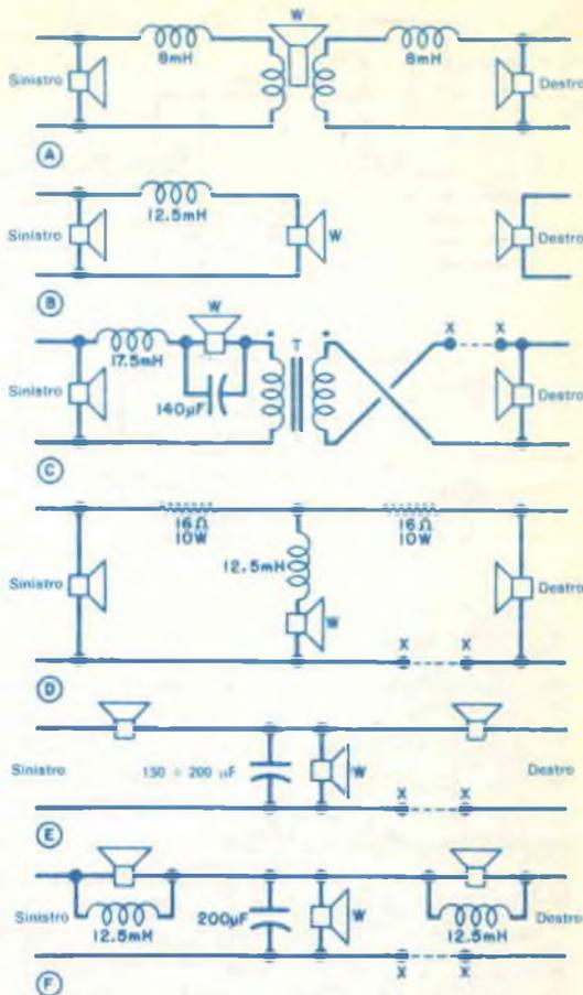
Fig. 1 - Non si usino i circuiti c) e f) con amplificatori a transistori senza inserire un condensatore di capacità elevata, da 500  $\mu\text{F}$ , tra i punti X e se l'amplificatore non è stabile con carico capacitivo.
