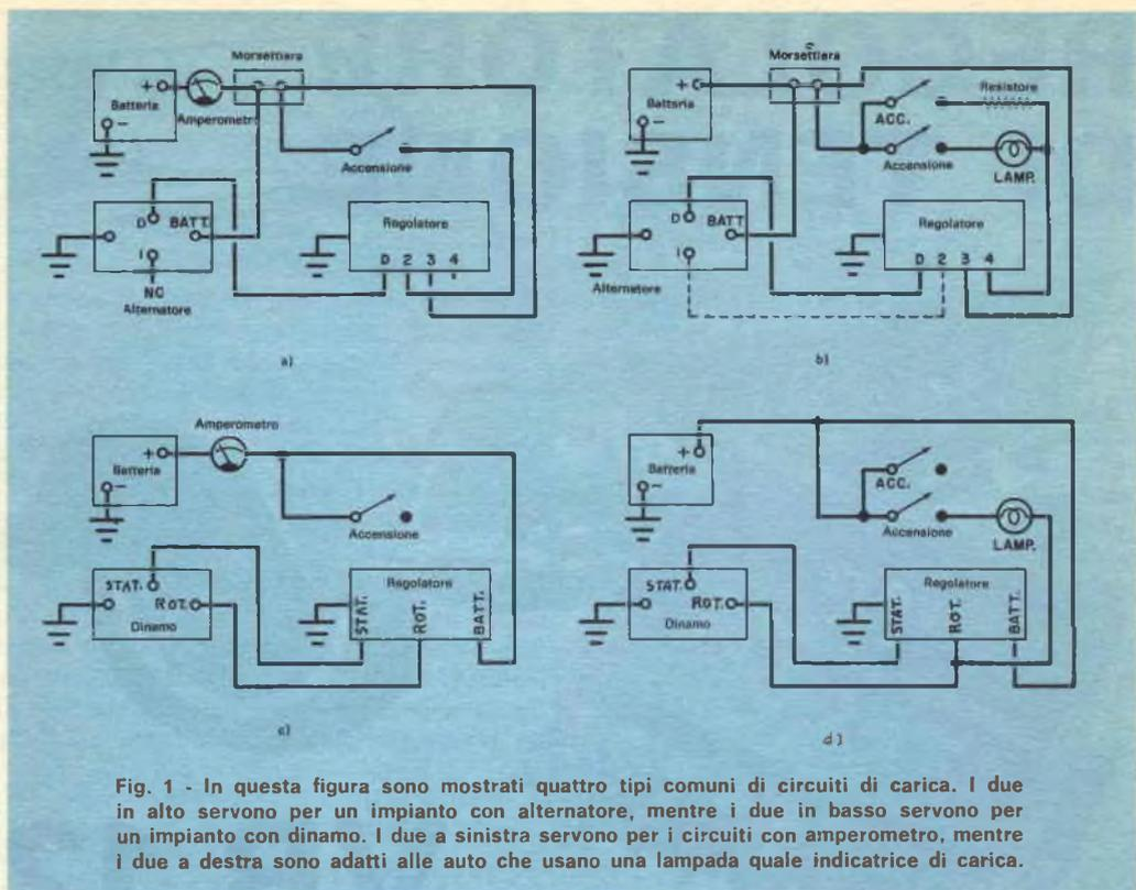
Fig. 1 - In questa figura sono mostrati quattro tipi comuni di circuiti di carica. I due in alto servono per un impianto con alternatore, mentre i due in basso servono per un impianto con dinamo. I due a sinistra servono per i circuiti con amperometro, mentre i due a destra sono adatti alle auto che usano una lampada quale indicatrice di carica.
