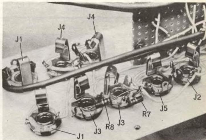
Il telaio dell'amplificatore-limitatore è fissato al pannello frontale con una piccola squadretta a L. I conduttori per le connessioni agli altri circuiti sono disposti sul lato inferiore del telaio.
