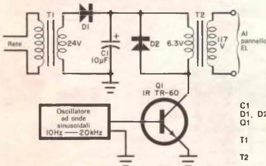
Fig. 4 - Per eccitare il transistore commutatore, in questo circuito pilota per pannelli viene usato un generatore audio esterno. Anche in questo caso l'uscita alternata è elevata; si faccia perciò attenzione nell'effettuare i collegamenti al pannello.
