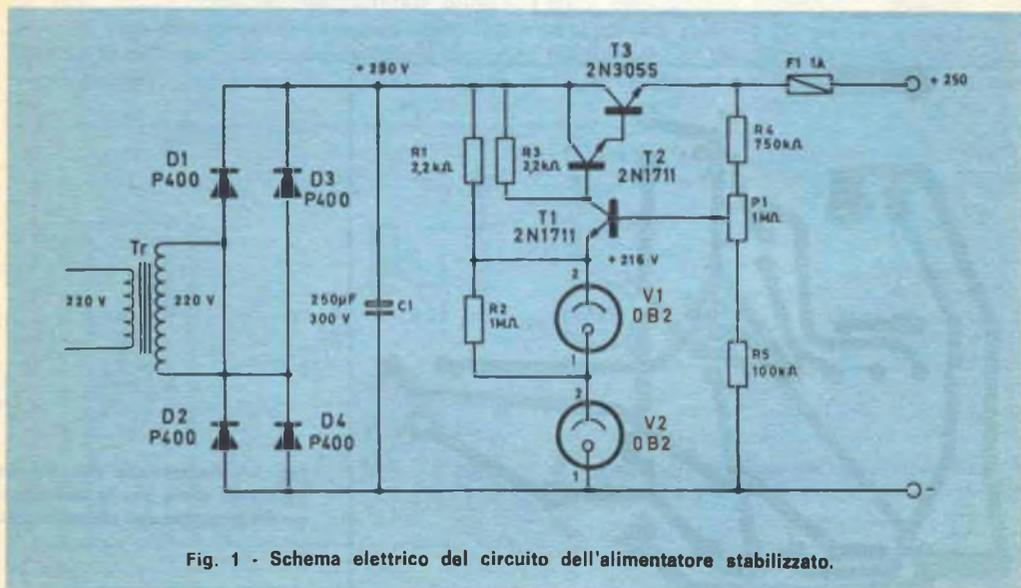
Fig. 1 - Schema elettrico del circuito dell'alimentatore stabilizzato.
