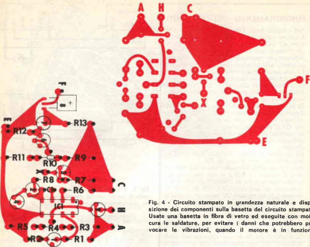
Fig. 4 - Circuito stampato in grandezza naturale e disposizione dei componenti sulla bassetta del circuito stampato. Usate una bassetta in fibra di vetro ed eseguite con molta cura le saldature, per evitare i danni che potrebbero provocare le vibrazioni, quando il motore è in funzione.
