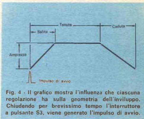
Fig. 4 - Il grafico mostra l'influenza che ciascuna regolazione ha sulla geometria dell'involuppo. Chiudendo per brevissimo tempo l'interruttore a pulsante S3, viene generato l'impulso di avvio.
