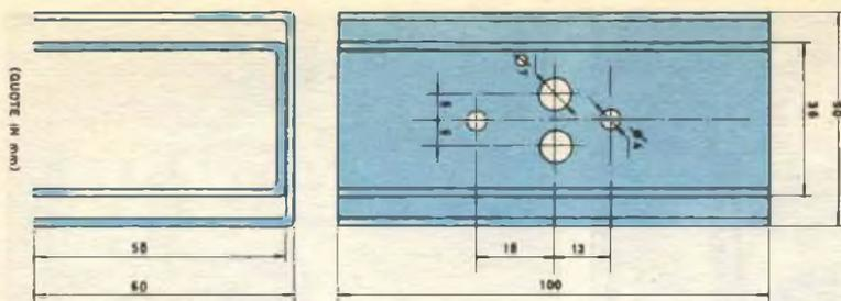
Fig. 5 - Disegno costruttivo e montaggio relativo al dissipatore di calore.
