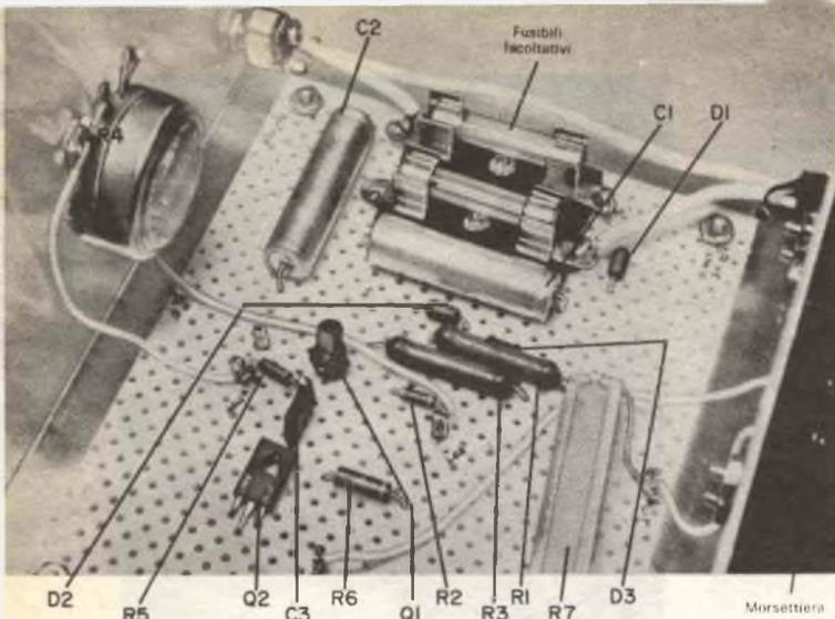
Dal momento che la disposizione delle parti non è critica, il circuito può essere montato su una basetta perforata. I collegamenti al pannello EL si effettuano per mezzo della morsetteria, posta nella parte posteriore del telaio. Il trasformatore d'isolamento è montato a un'estremità del telaio e viene usato per sicurezza.
