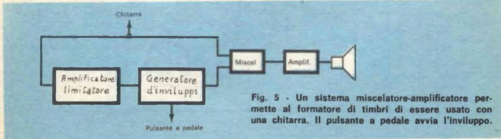
Fig. 5 - Un sistema miscelatore-amplificatore permette al formatore di timbri di essere usato con una chitarra. Il pulsante a pedale avvia l'involuppo.
