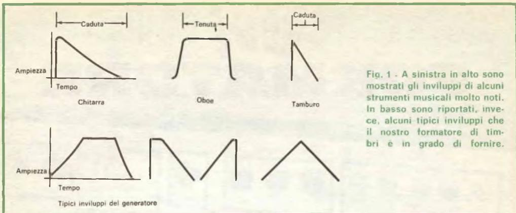
Fig. 1 - A sinistra in alto sono mostrati gli involucri di alcuni strumenti musicali molto noti. In basso sono riportati, invece, alcuni tipici involucri che il nostro formatore di timbri è in grado di fornire.
