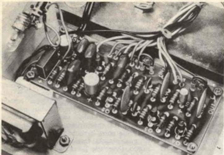
**Disponete ordinatamente i collegamenti dei comandi e delle prese su un lato del circuito stampato e uniteli insieme con un cavetto o con un elastico. Fissate il trasformatore di alimentazione al telaio mediante viti adatte; usate anche distanziatori da 6 mm per montare la basetta del circuito stampato.**
