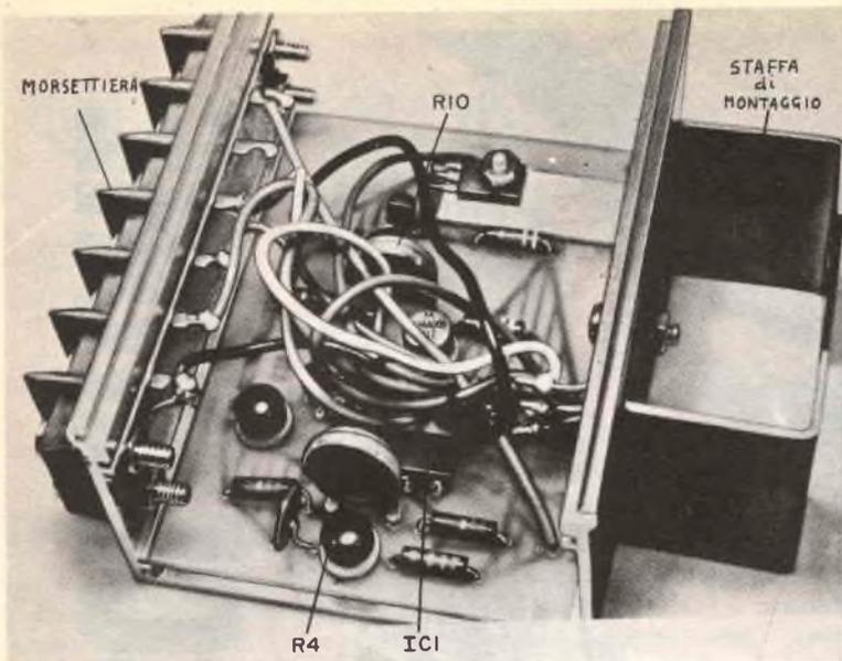
Il VR12 si può montare su un telaio piccolo ma robusto, in modo che sopporti le vibrazioni dell'auto. Usate rondelle elastiche per tutte le viti di fissaggio.
