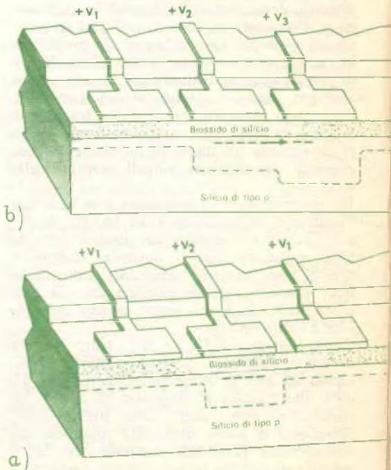
**Fig. 1** - Ecco come le cariche di segnale vengono trattenute e spostate nel nuovo dispositivo immagine con accoppiamento per mezzo di cariche della Bell. L'accumulo della carica è rappresentato in a) mentre b) mostra come le cariche si spostino quando un elettrodo adiacente viene portato ad una tensione positiva superiore. Probabilmente non è lontano il giorno in cui sarà progettata una camera TV tutta a stato solido, con l'uso di questo dispositivo.
