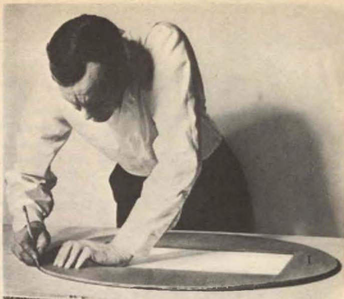
nelli possono essere realizzati con legno compensato d'abete da 20 mm, ricoperto con legno compensato duro da 5-6 mm.
