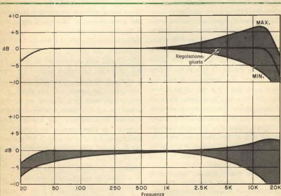
Le curve in alto mostrano la gamma dei responsi alle frequenze alte possibile mediante regolazione dell'equalizzazione di un tipico registratore. Le curve in basso mostrano come, per un determinato tipo di registratore, il responso in frequenza possa essere variato moltissimo cambiando semplicemente il tipo e la marca del nastro stereo.
