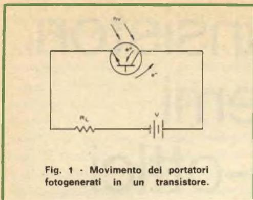
Fig. 1 - Movimento dei portatori fotogenerati in un transistor.
