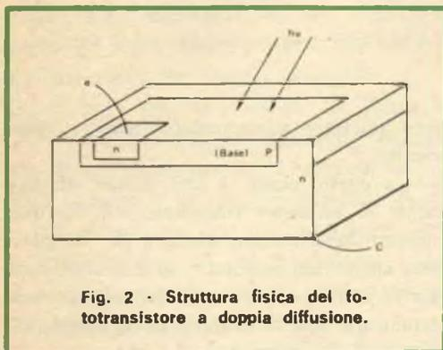
Fig. 2 - Struttura fisica del fototransistore a doppia diffusione.
