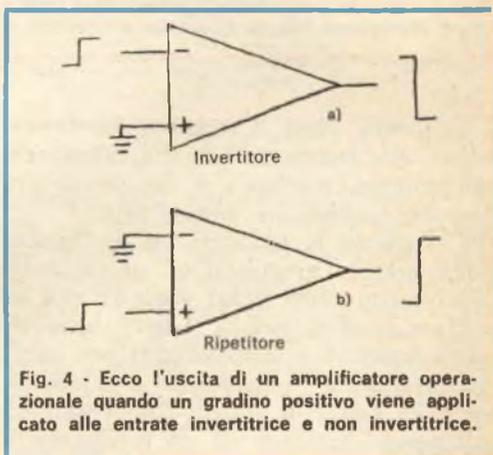
Fig. 4 - Ecco l'uscita di un amplificatore operazionale quando un gradino positivo viene applicato alle entrate invertitrice e non invertitrice.
