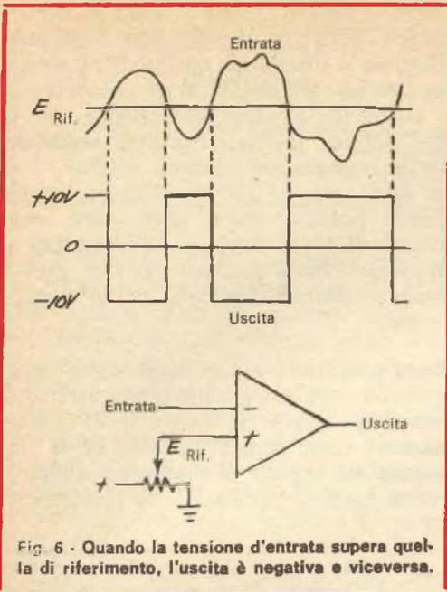
Fig. 6 - Quando la tensione d'entrata supera quella di riferimento, l'uscita è negativa e viceversa.
