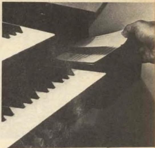
**Un lettore di cartoline perforate e memorie alterabili conferisce al nuovo organo un numero virtualmente illimitato di voci. Rappresentazioni numeriche di suoni musicali vengono immagazzinate su cartoline perforate per l'immagazzinamento temporaneo nel computer in aggiunta alle voci normali dell'organo.**
