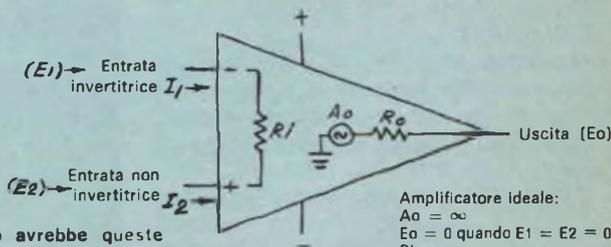
Fig. 2 - Un amplificatore perfetto avrebbe queste caratteristiche. Anche se non è ancora stato realizzato, un circuito del genere sarà con ogni probabilità attuabile in un futuro non molto lontano.
