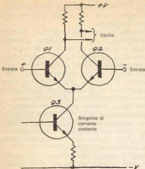
Fig. 3 - Negli amplificatori operazionali è incorporato questo tipo di amplificatore differenziale. La polarizzazione di Q3 determina l'entità della corrente che circola in Q1 e Q2. Una coppia differenziale produce una deviazione d'uscita molto più grande della semplice variazione ottenibile da un singolo transistor.
