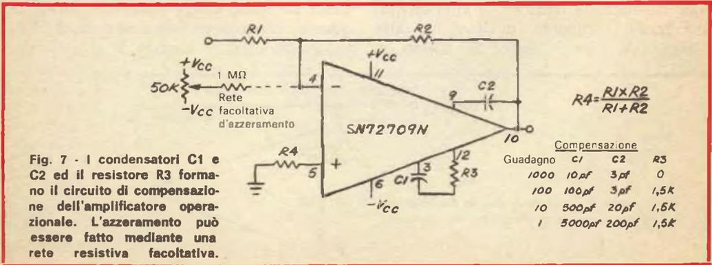
Fig. 7 - I condensatori C1 e C2 ed il resistore R3 formano il circuito di compensazione dell'amplificatore operazionale. L'azzeramento può essere fatto mediante una rete resistiva facoltativa.
