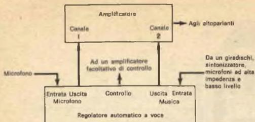
**Fig. 3 - Collegamenti tra il regolatore automatico a voce ed un sistema audio. Determinato il livello della musica ed il tempo di ritorno, il sistema è pronto a funzionare se si usa il microfono per un annuncio.**
