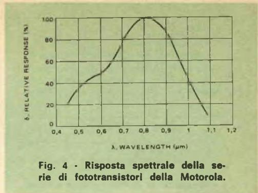
**Fig. 4 - Risposta spettrale della serie di fototransistori della Motorola.**
