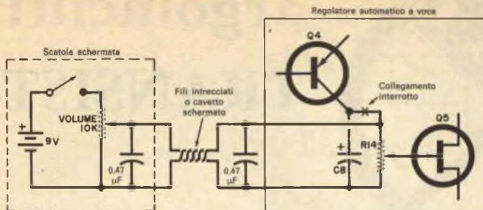
Fig. 4 - Questa modifica consente di controllare a distanza il volume di un amplificatore. In questo caso non si può usare il microfono. I condensatori riducono il ronzio captato.
