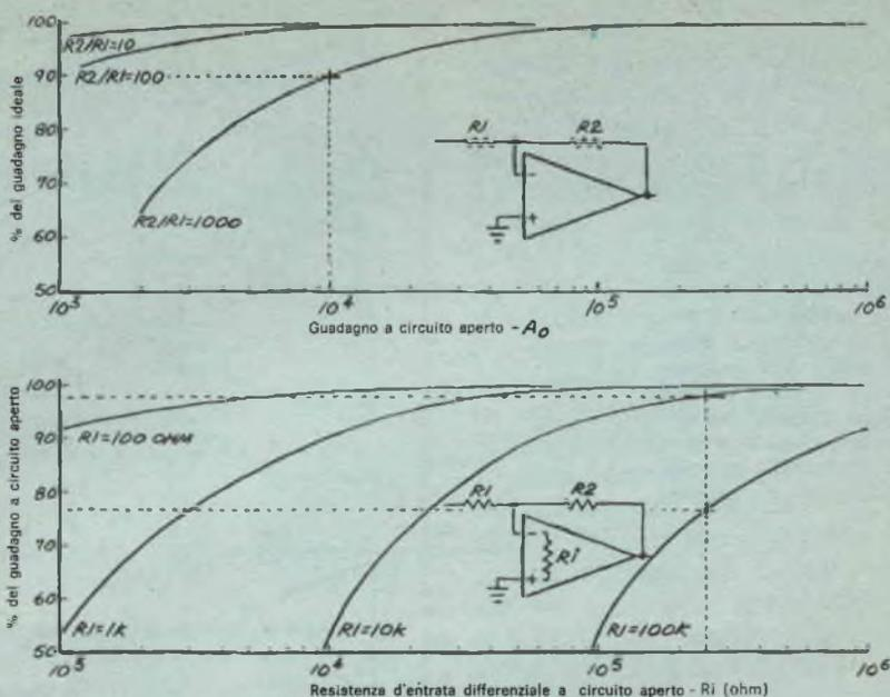
Fig. 9 - Guadagno a circuito aperto e resistenza d'entrata differenziale in funzione delle prestazioni.
