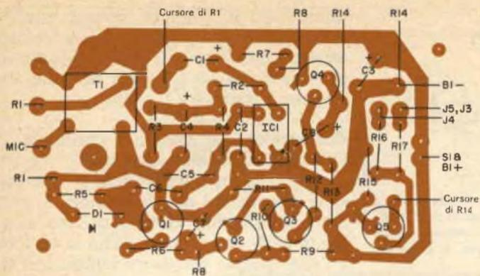
Fig. 2 - Circuito stampato in grandezza naturale e disposizione dei componenti. Si rispettino le polarità del circuito integrato, dei transistori e dei condensatori elettrolitici.
