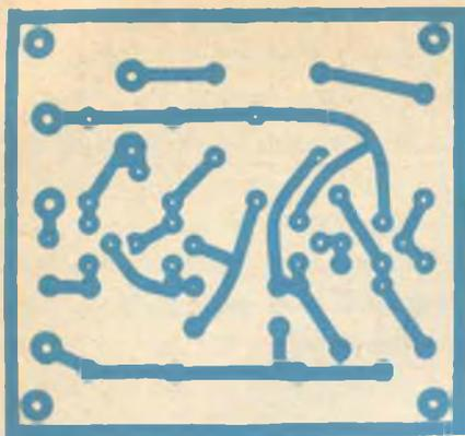
Fig. 3 - Circuito stampato in grandezza naturale (sopra) e disposizione dei componenti (a lato). Al posto del circuito stampato si può usare pure una basetta perforata.
