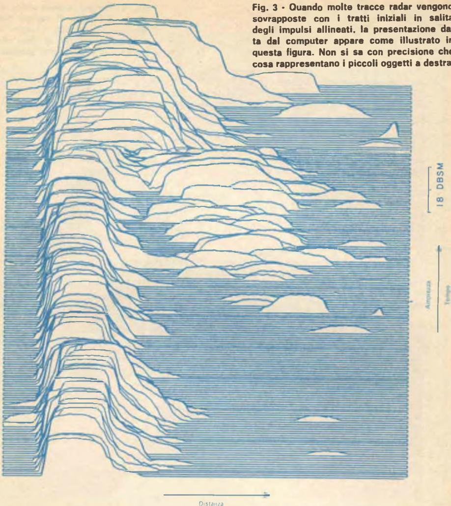
Fig. 3 - Quando molte tracce radar vengono sovrapposte con i tratti iniziali in salita degli impulsi allineati, la presentazione data dal computer appare come illustrato in questa figura. Non si sa con precisione che cosa rappresentano i piccoli oggetti a destra.
