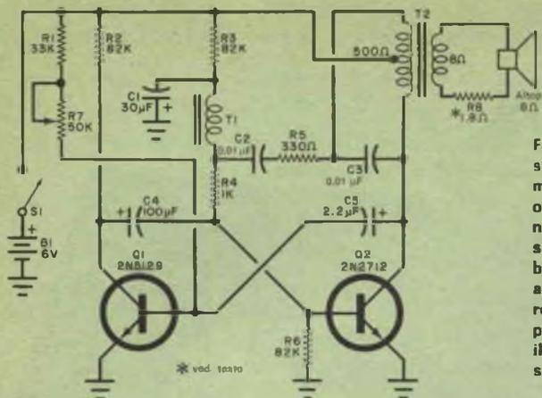
Fig. 1 - Questo circuito non è così semplice come sembra. Oltre ad un multivibratore, comprende anche un oscillatore bloccato. Tutti i componenti fanno parte di una delle costanti di tempo e perciò, se si cambia il valore di un componente, si altera il suono ottenuto. Si noti il resistore di smorzamento dell'altoparlante (R8), il quale impedisce che il carico acustico dell'altoparlante stesso possa influire sull'oscillatore.
