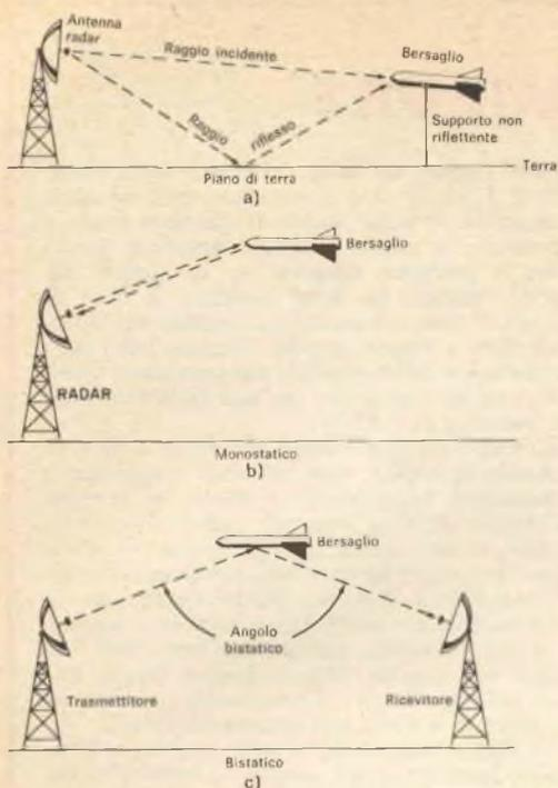
Fig. 5 - Tre tipi di metodi comunemente usati per ottenere misure di sezioni trasversali radar. Il bersaglio può essere in grandezza naturale od in scala e viene sospeso su supporti che non riflettono il radar.
