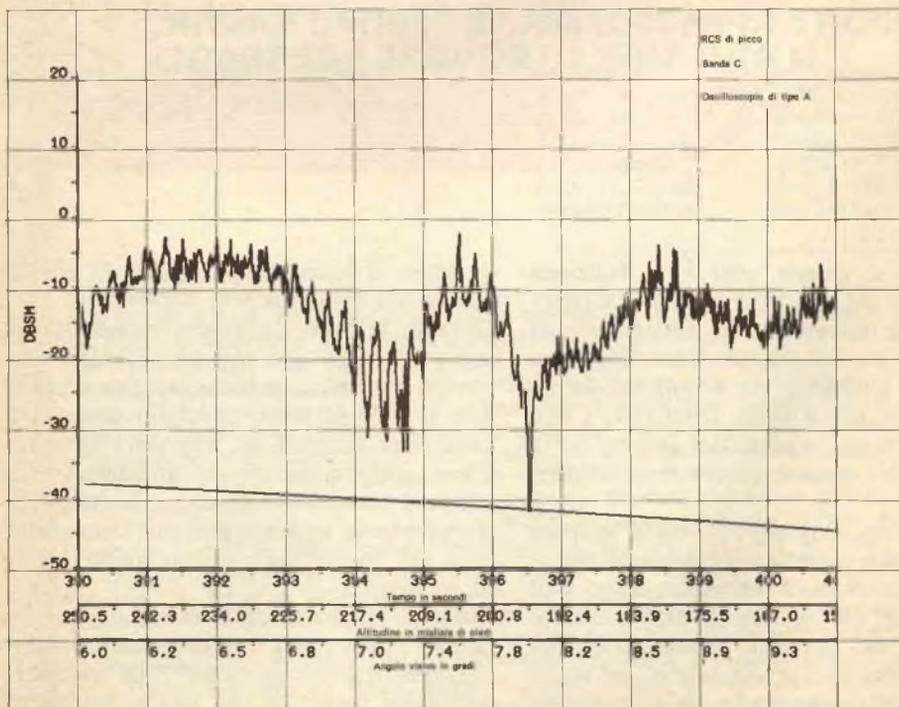
Fig. 2 - Il grafico mostra le variazioni dei ritorni dal bersaglio in funzione del tempo, dell'altitudine e dell'angolo visivo. Notare i picchi ad ogni secondo indicanti rotazione e una stretta punta a 396,5.
