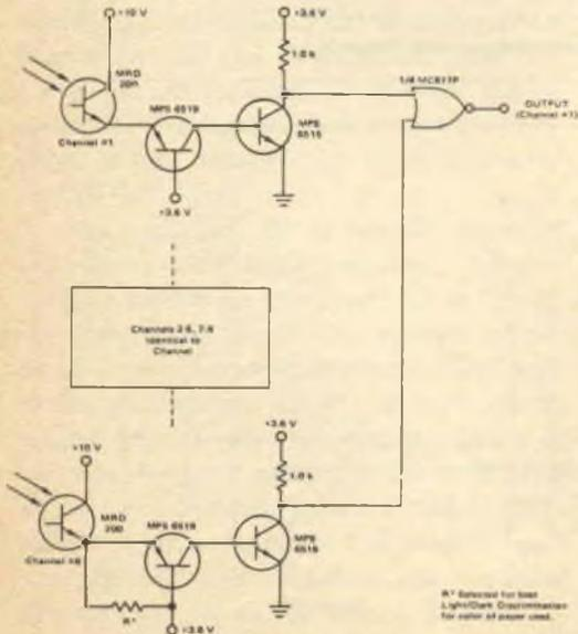
Fig. 11 - Circuito di lettura per lettore ottico di schede.
