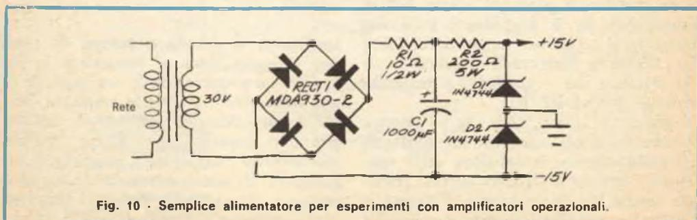
Fig. 10 - Semplice alimentatore per esperimenti con amplificatori operazionali.
