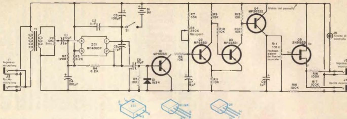
Fig. 1 - Il FET si comporta come un resistore variabile tra la linea della musica e massa. Quando un segnale audio percorre la linea del microfono, il livello della musica scende ad un livello predeterminato e ritorna al livello normale se il microfono non è più usato. Tutti i parametri sono controllabili.
