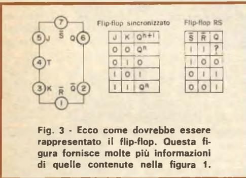
**Fig. 3** - Ecco come dovrebbe essere rappresentato il flip-flop. Questa figura fornisce molte più informazioni di quelle contenute nella figura 1.
