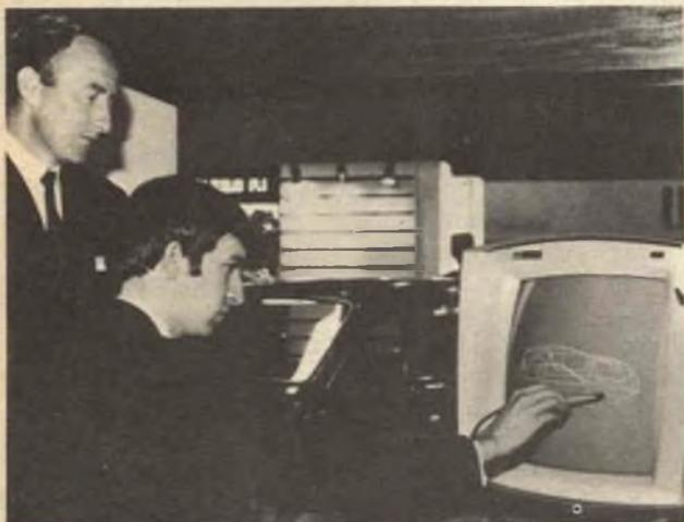
Un terminale video, dotato di una speciale "penna" elettronica e collegato ad un elaboratore IBM, consente a tecnici e stilisti della Pressed Steel Fisher di progettare e disegnare le carrozzerie di nuove auto.
