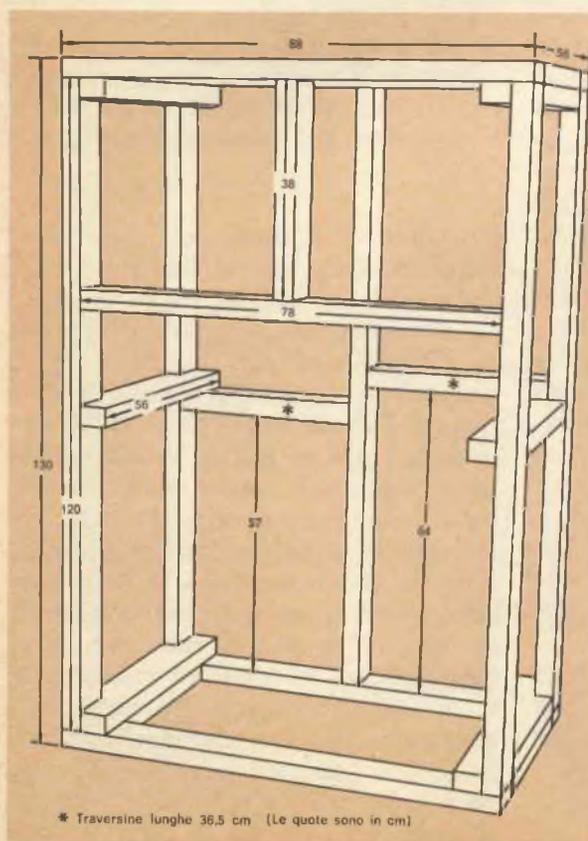
Fig. 1 - L'incastellatura del mobile si fa con traversine di abete da 5 x 10 cm, solidamente fissate con colla e viti da legno.
