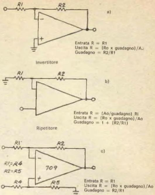
Fig. 8 - Tre impieghi tipici dell'amplificatore operazionale. Invertitore a), ripetitore b) e amplificatore differenziale c). Nella figura sono anche date le equazioni base per l'entrata, l'uscita ed il guadagno. L'uscita dell'amplificatore differenziale è proporzionale alla differenza di tensione tra i due segnali di entrata.
