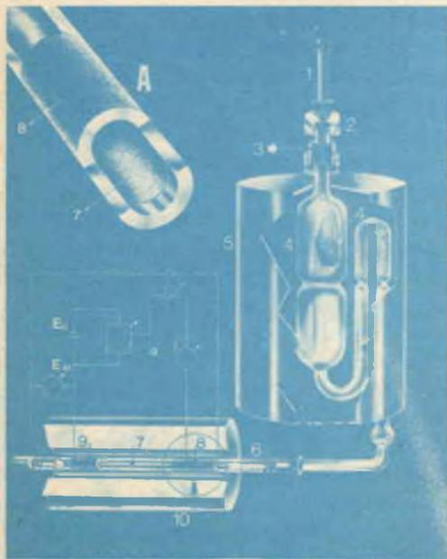
Principio di funzionamento dell'analizzatore automatico con tubo di ossido di zirconio, che misura con precisione il grado di inquinamento delle acque.
