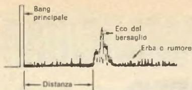
Fig. 1 - La traccia radar normale ha il bang principale all'inizio e l'eco proveniente dal bersaglio ad una certa distanza. La cosiddetta "erba" viene prodotta dal rumore del sistema.
