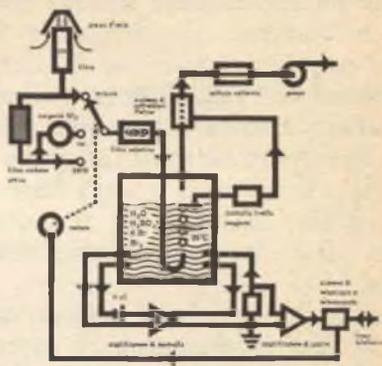
Schema di funzionamento dell'analizzatore di anidride solforosa, per la misura dell'inquinamento dell'aria.
