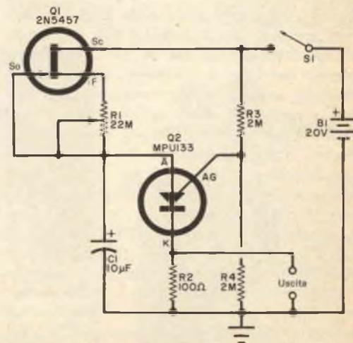
Fig. 2 - Con un FET ed un PUT si può costruire un temporizzatore che fornisce un impulso di uscita in tempi compresi tra pochi secondi e 20 minuti.
