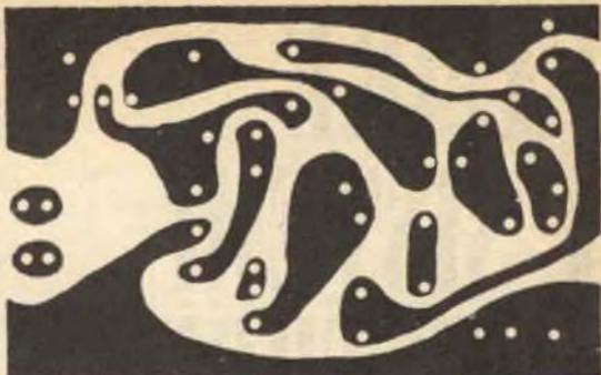
Fig. 2 - Circuito stampato in grandezza naturale e disposizione dei componenti. Si noti che in questo circuito stampato devono essere usati, per ovvie ragioni, trasformatori miniatura.
