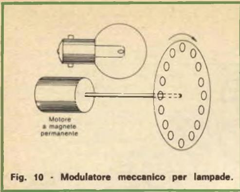
Fig. 10 - Modulatore meccanico per lampade.
