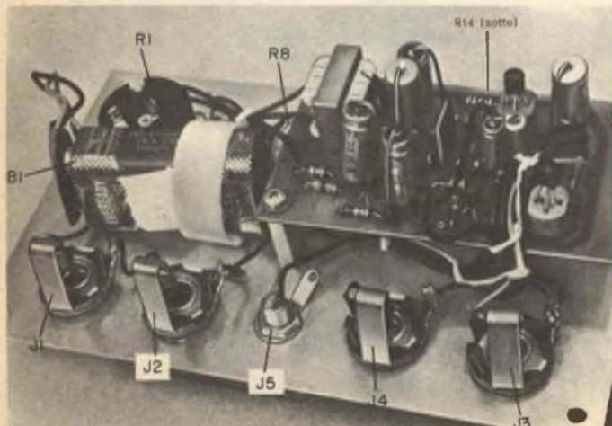
Al posto del Jack possono essere usati connettori di altro tipo. La batteria viene fissata con una fascia di plastica.
