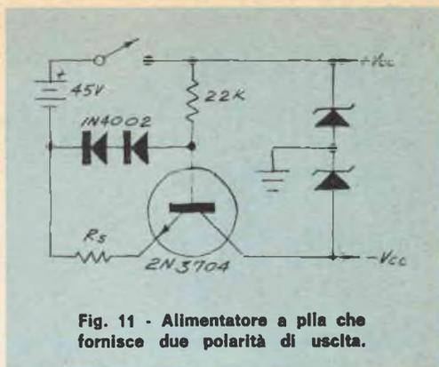
Fig. 11 - Alimentatore a pila che fornisce due polarità di uscita.
