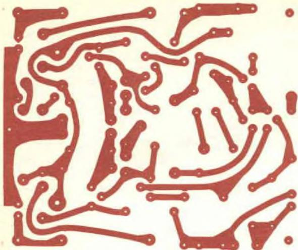
**Fig. 5 - Circuito stampato, rappresentato sopra, in grandezza naturale e, nella figura sotto, si vede la disposizione dei componenti sul circuito.**
