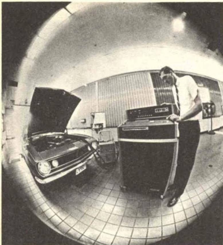
*Un tecnico riparatore sta compiendo una serie di prove di funzionamento programmate con cartoline perforate, impiegando un computer Al-len per la diagnosi motoristica. I risultati vengono scritti dal computer ed il cliente può prenderne visione.*
