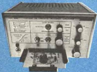
La Schlumberger ha progettato un nuovo strumento compatto, di concezione assolutamente nuova, il TCL 232 (ved. figura), che visualizza sullo schermo di un qualsiasi oscilloscopio X Y i parametri essenziali dei circuiti integrati lineari:
