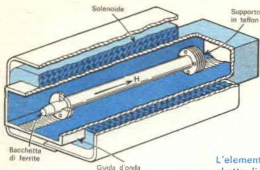
L'elemento rotatore di fase è composto da una bacchetta di ferrite montata dentro una guida d'onda.
