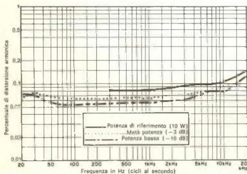
Le curve mostrano la distorsione armonica estremamente bassa su tutta la gamma audio ed a vari livelli di potenza.
