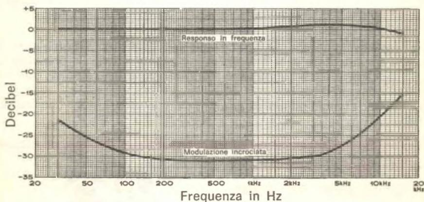
Nelle prime due figure in alto sono riportati rispettivamente i grafici della distorsione armonica e della distorsione totale, e nella figura sottostante i grafici del responso in frequenza e della modulazione incrociata; tutti i grafici sono relativi al radio ricevitore SX-2500 della Pioneer.
