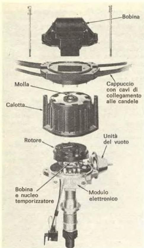
*Il sistema di accensione unificato della Pontiac raccoglie in unico blocco il distributore, la bobina ed il cavo di collegamento per le candele. Il blocco non ha bisogno di manutenzione. Le puntine sono sostituite da un generatore magnetico d'impulsi e da un controllo elettronico a circuito integrato.*
