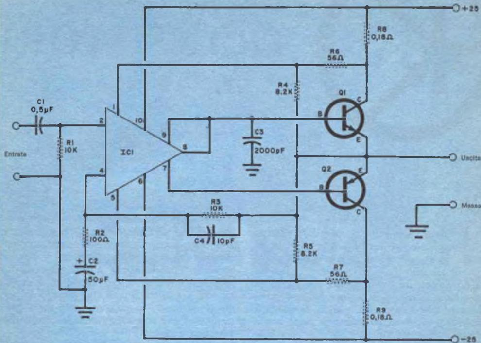
**Fig. 1 - L'amplificatore di potenza AB a circuito integrato SE/NE 540L della Signetics viene usato, in questo caso, in un amplificatore audio da 35 W per pilotare due transistori complementari nello stadio d'uscita.**
