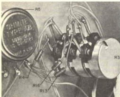
**Il potenziometro di frequenza è triplo ed i resistori sono collegati direttamente come si vede qui sopra.**
