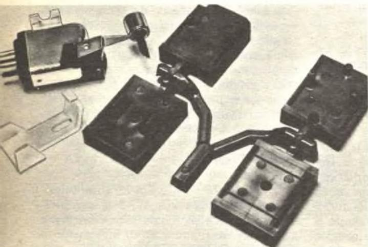
La ditta Pickering ha reso il montaggio delle cartucce ancora più facile fornendo al compratore vari tipi di sistemi di montaggio ad innesto in plastica. Nella foto si vedono alcuni di questi accessori.
