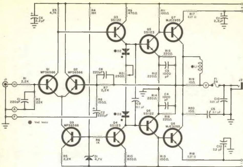
**Fig. 1 - Per portare il responso in frequenza quasi alla c.c., in tutto l'amplificatore vengono usati accoppiamenti diretti. L'uscita è provvista di un fusibile per evitare che gli altoparlanti si possano danneggiare in caso di guasti di Q7-Q8.**
