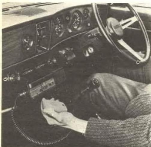
**Fig. 1 - Equipaggiamento della Serie Pye EUROPA, installato su un'autovettura.**
