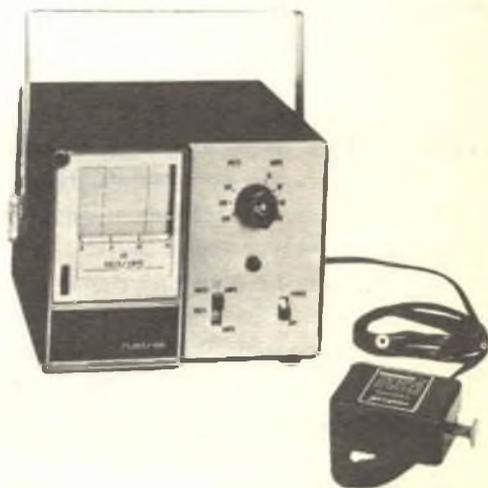
Sono fornite pinze a griffe per la misura della tensione. Un trasduttore a pinza permette la registrazione della corrente senza interruzione del carico e senza necessità di connessioni alla linea. Il sistema di scrittura è senza inchiostro.
