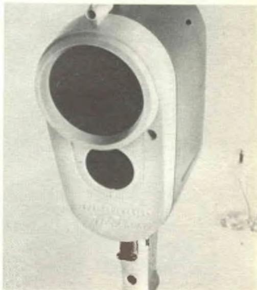
*I semplici apparecchi di comunicazione a raggio luminoso, come questo costruito dalla Infrared Industries Inc., impiegavano filtri infrarossi su sorgenti di luce bianca per rendere il raggio invisibile e ridurre l'interferenza dovuta alla luce ambientale.*
