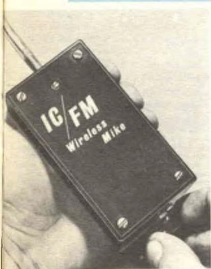
Il dispositivo che presentiamo, abbastanza economico, potrà interessare molti lettori. Si tratta di un microfono trasmettitore di cui nella *fig. 1* è riportato il circuito. È costituito da un circuito integrato (CA3018) e può trasmettere in una frequenza libera della gamma commerciale 88-108 MHz, con una portata compresa tra 20 m e 50 m, secondo il tipo e la posizione dell'antenna usata per il ricevitore.
