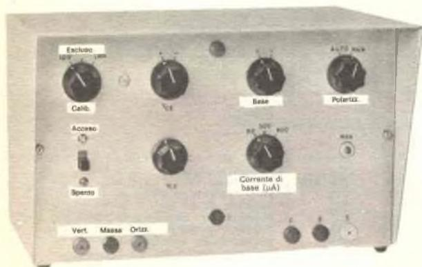
I tracciatori di curve caratteristiche di semiconduttori sono usati di rado dagli sperimentatori e dai dilettanti solo perché pochi ne conoscono bene il funzionamento. Inoltre, le unità commerciali sono costose. Tuttavia, un tracciatore di curve è quasi indispensabile se si vogliono conoscere le caratteristiche dei semiconduttori di cui si dispone, specialmente quando necessitano due semiconduttori appaiati per una particolare applicazione.
