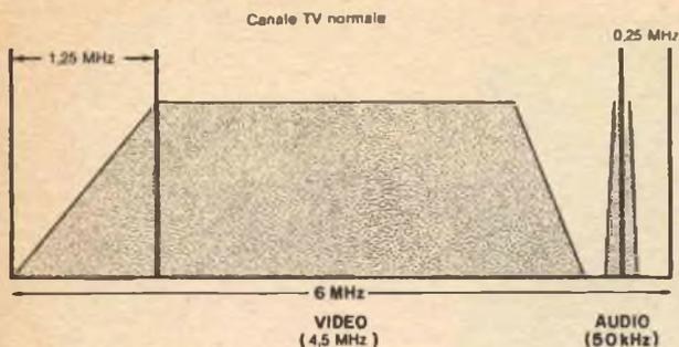
Fig. 1 - Il diagramma illustra il valore in frequenza di un normale segnale televisivo.
