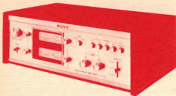
Decodificatore Sony a logica completa SQD-2020; questo apparecchio ha sostituito il SQD-2000, il primo decodificatore a logica completa.
