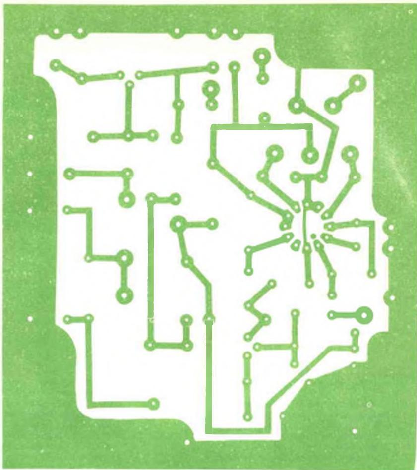
*Fig. 3 - Illustrazione del circuito stampato per gli stadi RF e disposizione dei componenti.*
