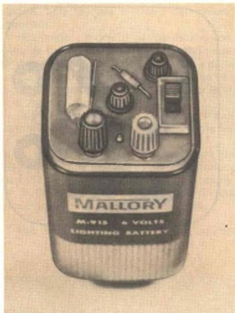
L'acquisto di un alimentatore stabilizzato a 3,6 V c.c., indispensabile quando si lavora con circuiti integrati, comporta una spesa non indifferente, giustificabile solo se si compiono molto spesso esperimenti con IC. Diversamente, si può ricorrere ad una soluzione: costruire un adattatore che fornisca una uscita stabile a 3,6 V c.c. da usare in unione con una batteria normale da 6 V per lanterne.
