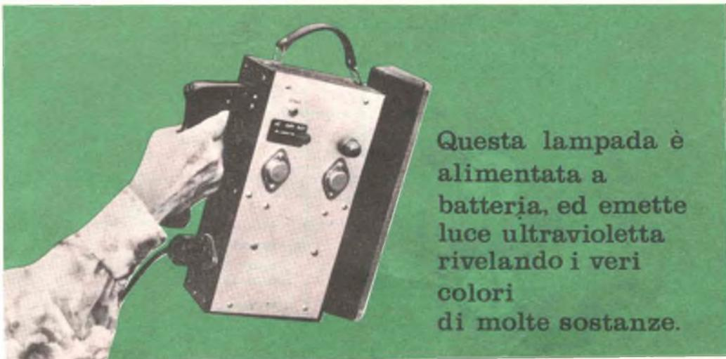
Questa lampada è alimentata a batteria, ed emette luce ultravioletta rivelando i veri colori di molte sostanze.
