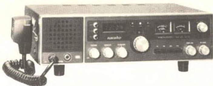
Il ricetrasmittitore CB MA/SSB a ventitré canali mod. TRC-57 realizzato dalla Realistic vanta parecchie caratteristiche che lo rendono particolarmente raccomandabile. Innanzitutto, nel ricetrasmittitore è inserito un sintetizzatore di frequenza a blocco di fase che elimina la necessità di impiegare cristalli per i canali; inoltre un orologio numerico elettronico con presentazione a LED completa degnamente la sofisticata apparecchiatura.
