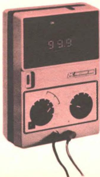
L'analizzatore numerico modello 280 della B & K Precision ha le dimensioni, la forma e le funzioni dei tradizionali analizzatori analogici, dai quali, si differenzia solo per il fatto che in esso l'indicazione è numerica.
