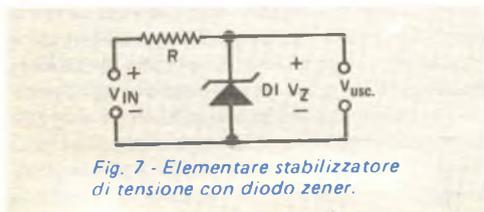
Fig. 7 - Elementare stabilizzatore di tensione con diodo zener.
