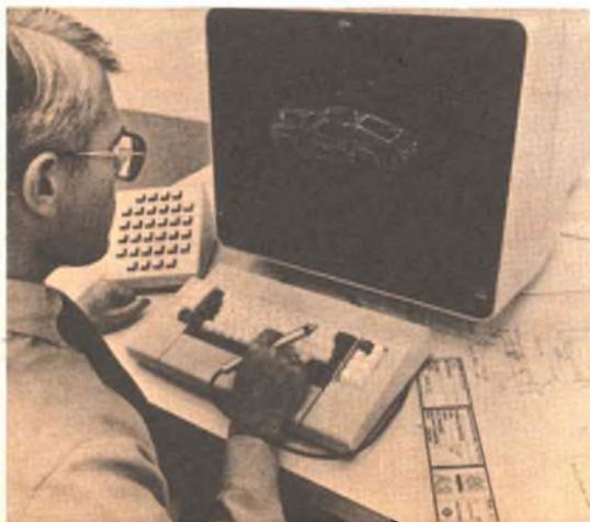
Il terminale, denominato Sistema Video Grafico IBM 3250, può essere collegato ad un elaboratore del Sistema/370 ed è costituito da una unità di controllo di canale IBM 3258, da una unità di controllo video IBM 3255 e dal terminale video IBM 3251.
